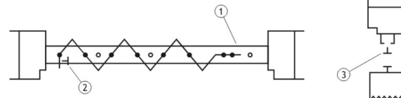
(2) Vrut s podložkou - Skrutka s podložkou - Schraube mit der Scheibe - Csavarok
