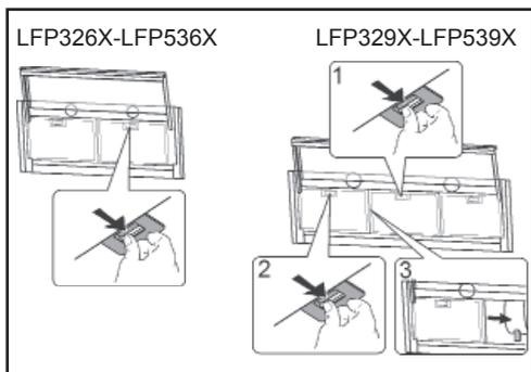
El filtro activo de carbón no se puede limpiar ni renovar y tiene que ser reemplazado aproximadamente cada 4 meses de uso o con mas frecuencia si se lo usa de una forma muy intensa.
