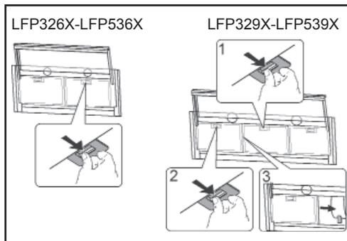
I filtri al carbone attivo non sono lavabili e non possono essere rigenerati, devono essere sostituiti approssimativamente ogni 4 mesi, o più frequentemente secondo l'uso.
