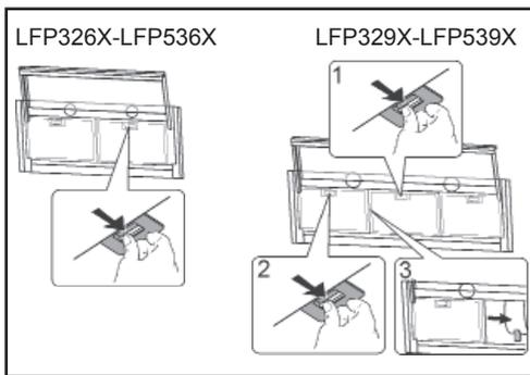
Az aktív szénzsűrő se nem tisztítható és se nem újítható fel, ezért kb. 4 havonta (illetve intenzív használat esetén sűrűbben) cserélni kell.
