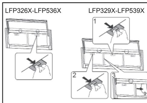
Aktivní filtr z dřevného uhlí není vhodný pro čištění a obnovu a je nutné ho měnit cca. každé 4 měsíce provozu nebo častěji, a v případě zvláště intenzivního používání ještě častěji.
