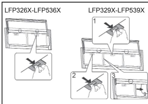
Le filtre à charbon de bois activé ne doit pas être nettoyé, est irremplaçable et doit être remplacé tous les 4 mois d'utilisation ou plus souvent en cas d'utilisation particulièrement intensive.
