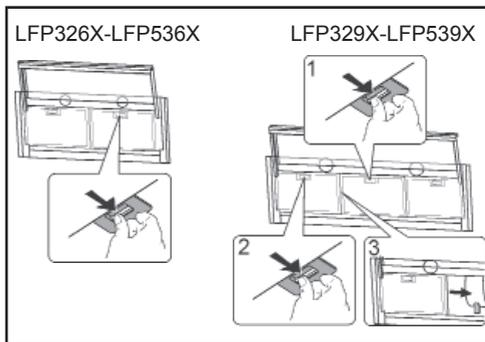
Aktivoitu puuhiilisuo-datin ei sovellu puhdistettavaksi eikä sitä voida uudistaa ja se pitää vaihtaa noin joka 4. käyttökuukausi tai useammin, jos käyttö on erityisen intensiivistä.
