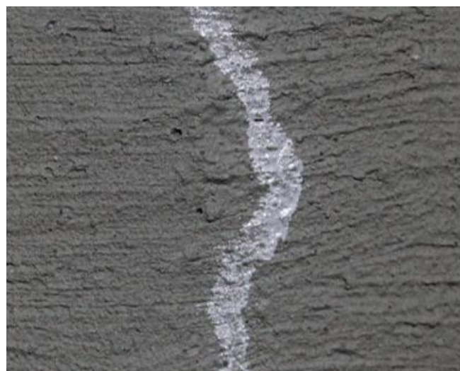
Fot. 5. Powolne narastanie kryształów soli na powierzchni rysy, doszczelnienie. Efekt po 35 dniach.
