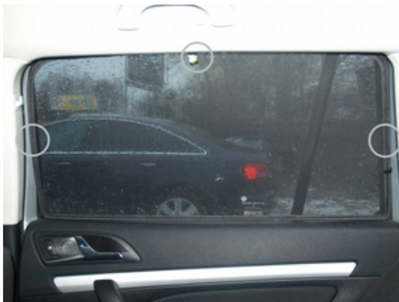
Rys.1 - Miejsca założenia blaszek na drzwiach
