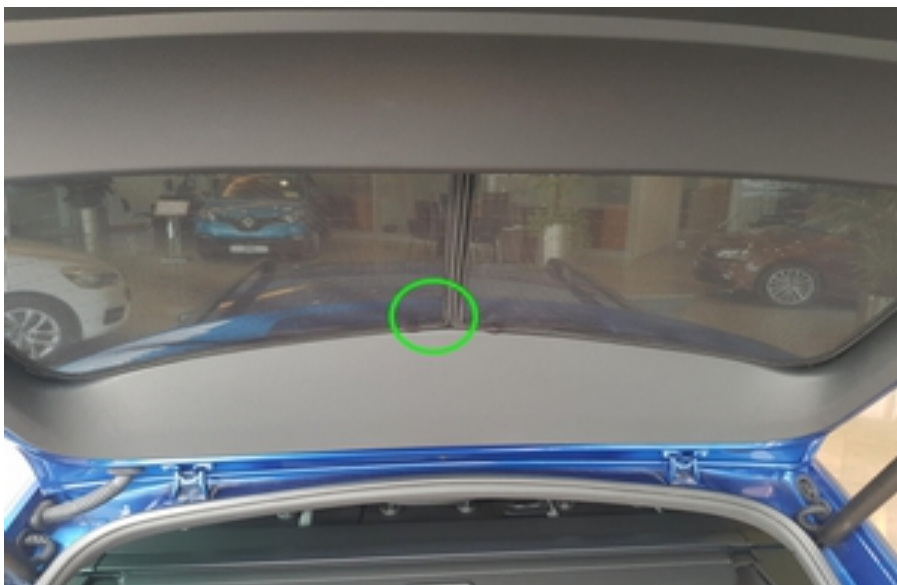
Rys.7 – Położenie rogu zasłonki z kątem prostym
