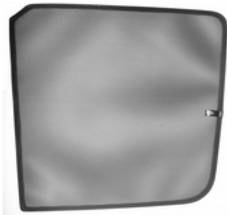
Rys.6 – prawidłowe ułożenie zasłonki przed wpasowaniem jej w szybę klapy bagażnika
