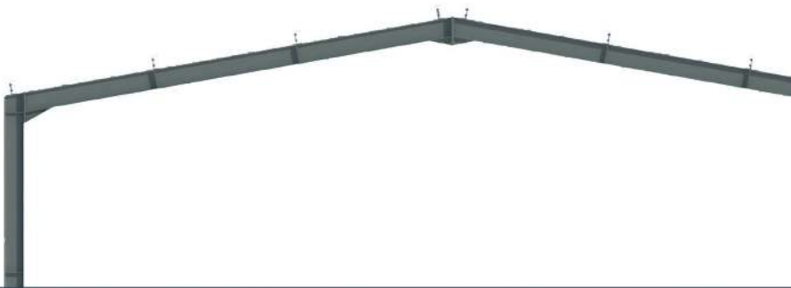
Rama pełnościenna z dwuteownika ze ściągiem
