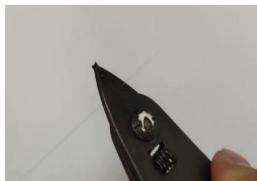
Po zdjęciu włókna optycznego, użyj bezpyłowego papieru zanurzonego w alkoholu o czystości 99%, aby oczyścić warstwę powłoki w kierunku okrężnym. Zaczynając od interfejsu między powłoką a gołym włóknem, obróć papier w kierunku gołego włókna w kierunku okrężnym i pozbądź się resztek warstw powłoki.
