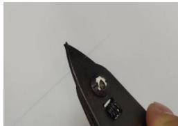
Après avoir dénudé la fibre optique, utilisez du papier sans poussière trempé dans de l'alcool pur à 99 % pour nettoyer la couche de revêtement dans une direction circulaire. En partant de l'interface entre le revêtement et la fibre nue, faites tourner le papier dans la direction de la fibre nue dans une direction circulaire et éliminez les débris des couches de revêtement.
