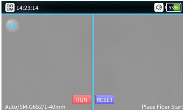
Interface d'observation de la fibre optique : appuyez brièvement sur l'interrupteur d'alimentation, puis l'indicateur du panneau de commande devient rouge et le buzzer émet un son semblable à « Di Di ». Tous les moteurs reviennent à leur position initiale et l'interface d'observation de la fibre s'affiche.
