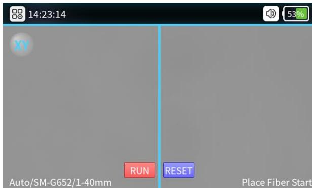
Observationsgränssnitt för optisk fiber: Tryck kort på strömbrytaren, så kommer indikatorn på manöverpanelen att bli röd och summern kommer att ljuda som "Di Di ". Alla motorer kommer att återgå till sina ursprungliga positioner och fiberobservationsgränssnittet visar.
