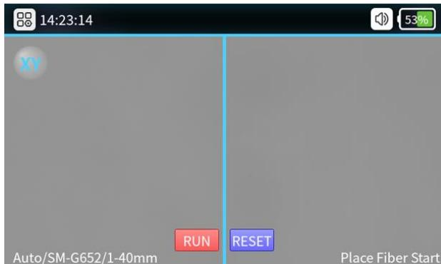
Optische vezelobservatie-interface: druk kort op de aan/uit-schakelaar, dan wordt de indicator op het bedieningspaneel rood en klinkt de zoemer zoals "Di Di ". Alle motoren keren terug naar hun beginposities en de vezelobservatie-interface geeft dit weer.
