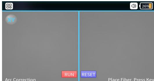
◆ **Sukces korekcji ARC** (Po wyświetleniu komunikatu „success” na ekranie, proces korekcji ARC zostanie ukonczony; nalezy wtedy nacisnac przycisk [Reset], aby wyjsc z trybu.)
