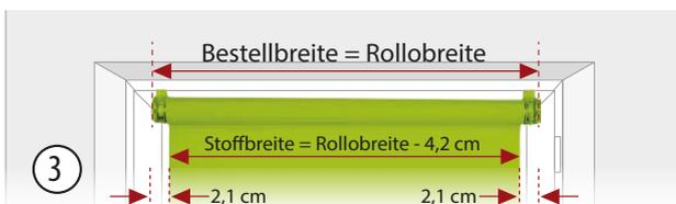
Die Bestellbreite entspricht dem Außenmaß des Rollos. Die Stoffbreite ist ca. 4,2 cm schmaler. (Abb. 3).
