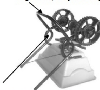
Hopper Support/ Wspornik Zbiornika
