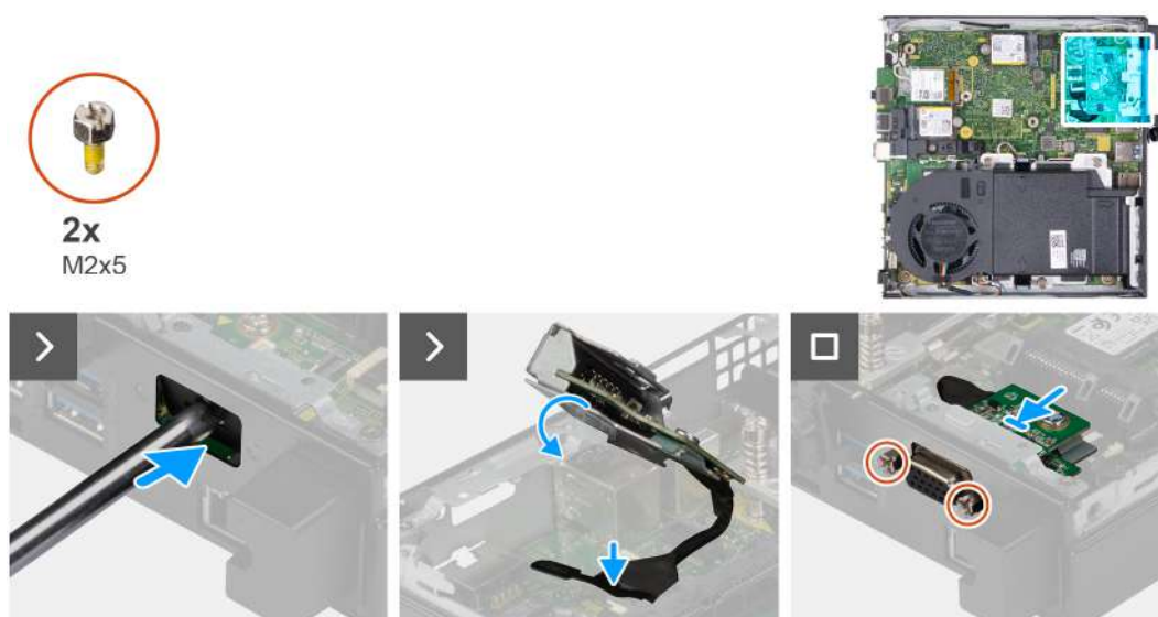
Rysunek 37. Instalowanie opcjonalnego modułu we/wy (VGA lub port szeregowy)
