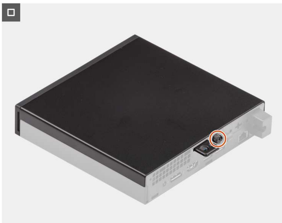
Rysunek 12. Instalowanie pokrywy bocznej
