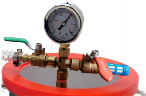
5. Na de verbinding , start de stroom normaal gesproken , en jij kan zien Dat de wijzer druk van de vacuüm graadmeter zal roteren .
