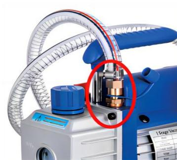
4. De interface op de ander einde van de slang is verbonden met de vacuüm meter , en de ventiel schakelaar is getoond in het figuur .
