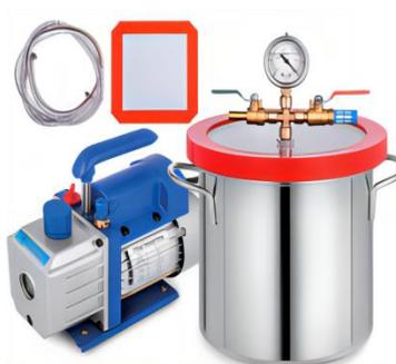
3 . Dopo il riempimento IL vuoto pompa , collegare IL tubo flessibile A l'aria ingresso ugello Di IL vuoto pompa .
