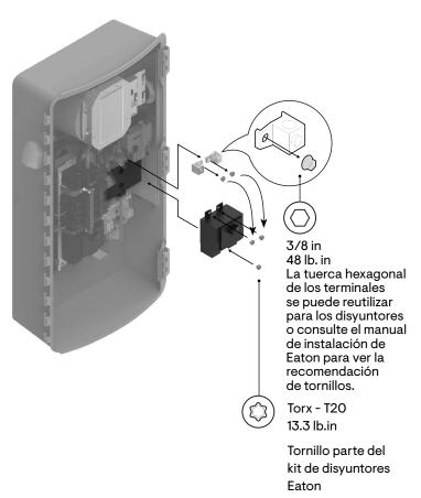
**ADVERTENCIA:** Apriete la tuerca hexagonal ① y vuelva a comprobar el par de apriete antes de cada instalación de cables.
