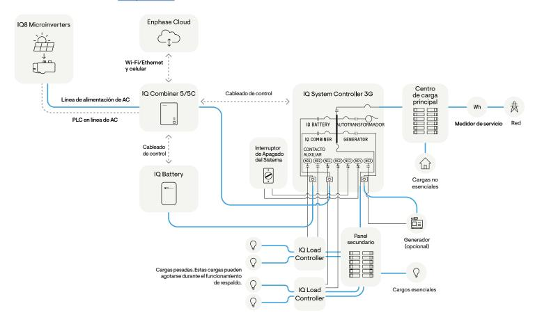
**NOTA:** El Interruptor de Apagado del Sistema no se utiliza para los sistemas IQ6, IQ7 y de la M Series. Consulte la sección <u>Cableado para la desconexión del sistema</u> para obtener más detalles.
