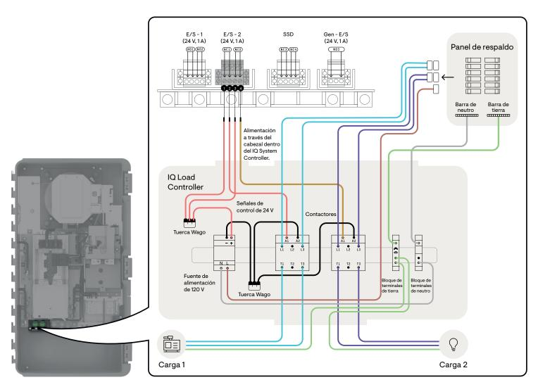
NOTA: Las líneas de control a los cabezales admiten calibres de cable 28 AWG y 16 AWG.
