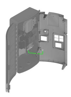
La conexión a tierra del frente muerto debe desconectarse cuidadosamente antes de desmontar el frente muerto del IQ System Controller.
