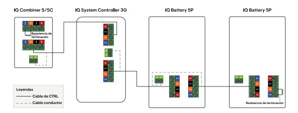
NOTA: La longitud total del cableado CTRL en todo el sistema no debe superar los 250 pies para garantizar que el sistema funcione según las especificaciones.
