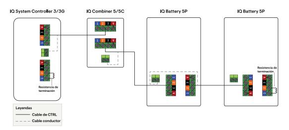
NOTA: La longitud total del cableado CTRL en todo el sistema no debe superar los 250 pies para garantizar que el sistema funcione según las especificaciones.
