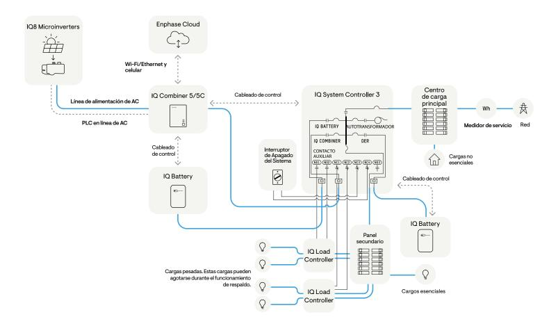
NOTA: El Interruptor de Apagado del Sistema no se utiliza para los sistemas IQ6, IQ7 y de la M Series. Consulte la sección <u>Cableado para la desconexión del sistema</u> para obtener más detalles.
