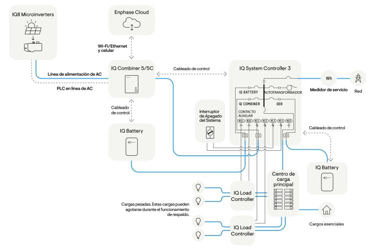
NOTA: El Interruptor de Apagado del Sistema no se utiliza para los sistemas IQ6, IQ7 y de la M Series. Consulte la sección <u>Cableado para la desconexión</u> del sistema para obtener más detalles.
