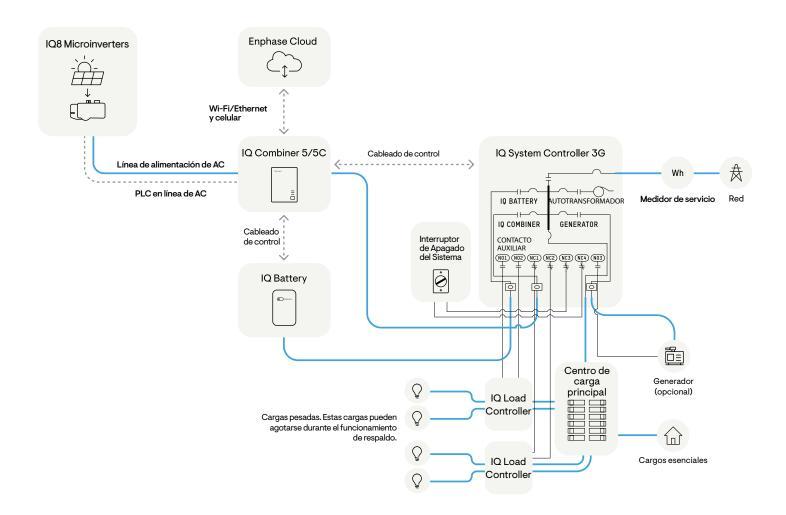
NOTA: El Interruptor de Apagado del Sistema no se utiliza para los sistemas IQ6, IQ7 y de la M Series. Consulte la sección <u>Cableado para la desconexión del sistema</u> para obtener más detalles.
