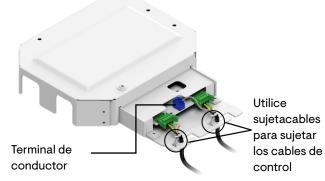
Escenario B: El IQ System Controller no es el nodo terminal para la red de control cableada. Utilice un cable de control de 40 pulgadas de longitud + la longitud del conducto en cada lado.
