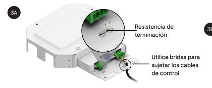
Escenario A: El IQ System Controller es el nodo terminal para la red de control cableada. Utilice un cable de control de 40 pulgadas de longitud + la longitud del conducto y utilice la resistencia de terminación suministrada con el Lit Kit.
