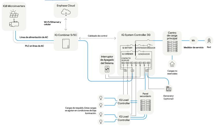
NOTA: ElInterruptor de Apagado del Sistema no se utiliza para los sistemas IQ6, IQ7 y M Series. Consulte la sección <u>Cableado para la desconexión del sistema</u> para obtener más detalles.
