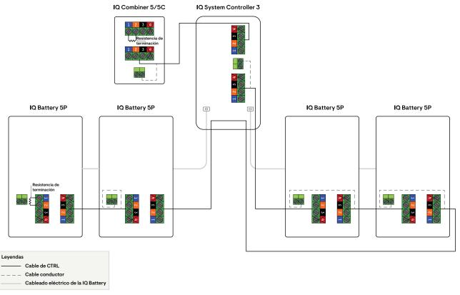
NOTA: La longitud total del cableado CTRL en todo el sistema no debe superar los 250 pies para garantizar que el sistema funcione según las especificaciones.
