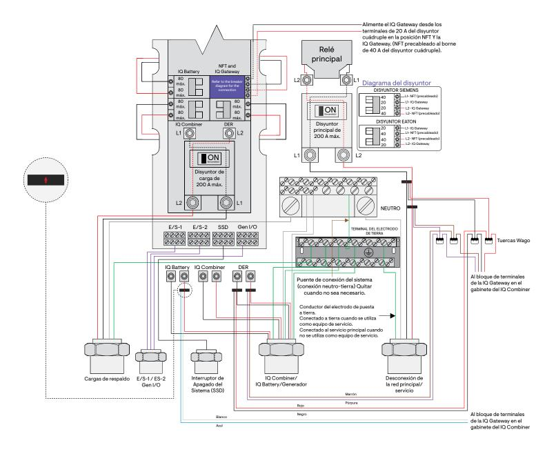
El transformador de corriente de batería se coloca en el cable L2 de la IQ Battery.
