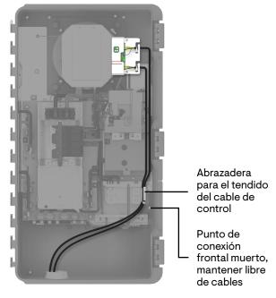
Tendido de los cables de control dentro del IQ System Controller.
