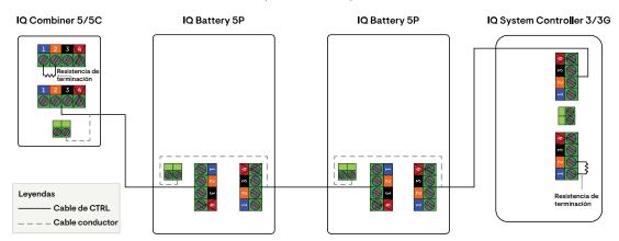
NOTA: La longitud total del cableado de CTRL en todo el sistema no puede superar los 250 pies para garantizar que el sistema funcione según las especificaciones.
