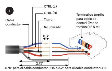
El cable de control debe pelarse a las dimensiones recomendadas y conectarse al cabezal.
