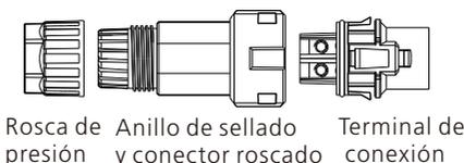
2. Inserte el cable pelado y desnudo en un tronillo de presión, anillo de sellado, conexión roscada en secuencia, inserte los cables en la terminal de conexión de acuerdo a la polaridad indicada en ellos y apriete los tornillos firmemente. Trate de jalar el cable para asegurar que este bien conectado.
