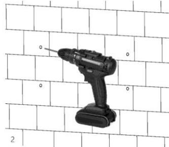
**Paso 2:** Instale y apriete los pernos de expansión en los agujeros. Luego, utilice las tuercas y arandelas correspondientes (incluidas junto con los pernos de expansión) para instalar y fijar el soporte de montaje en la pared.
