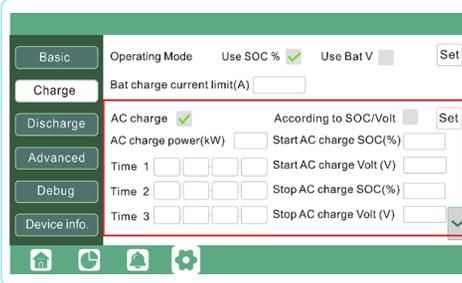
Los usuarios pueden cargar baterías con energía de la red cuando los precios de la electricidad son baratos y descargar energía de la batería para alimentar la carga o exportar a la red cuando los precios de la electricidad son altos.
