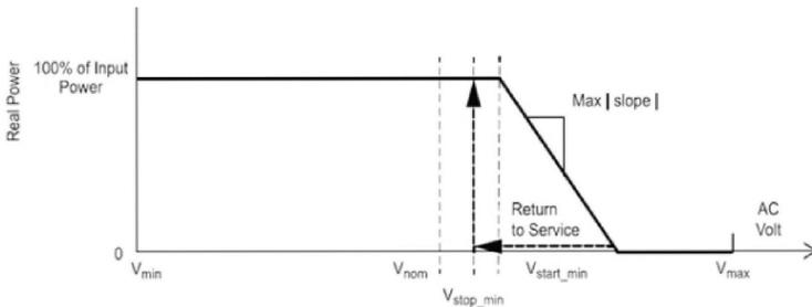
Cuando el voltaje de la red excede V1, la potencia activa de salida varía con el voltaje de la red.
