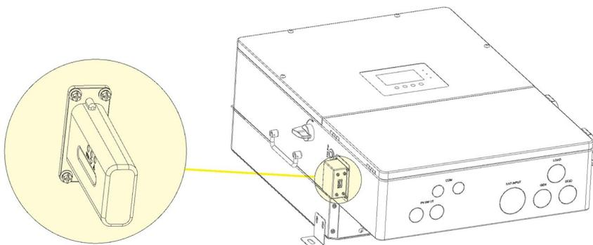
Al instalar el inversor, asegúrese de que el dongle esté conectado al inversor.
