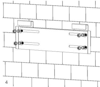
**Paso 3:** Cuelgue el inversor en el soporte de montaje y fíjelo en la pared utilizando 2 tornillos autorroscantes en la parte superior del inversor. Fije los tornillos de seguridad en los lados izquierdo y derecho.
