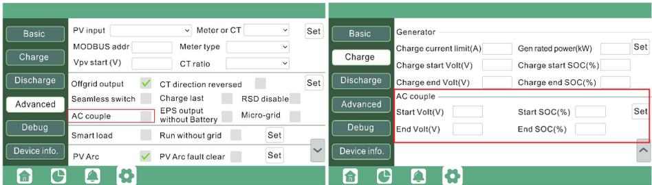
Los usuarios deben habilitar la función de acoplamiento de CA cuando conectan el sistema existente en la red al terminal GEN
