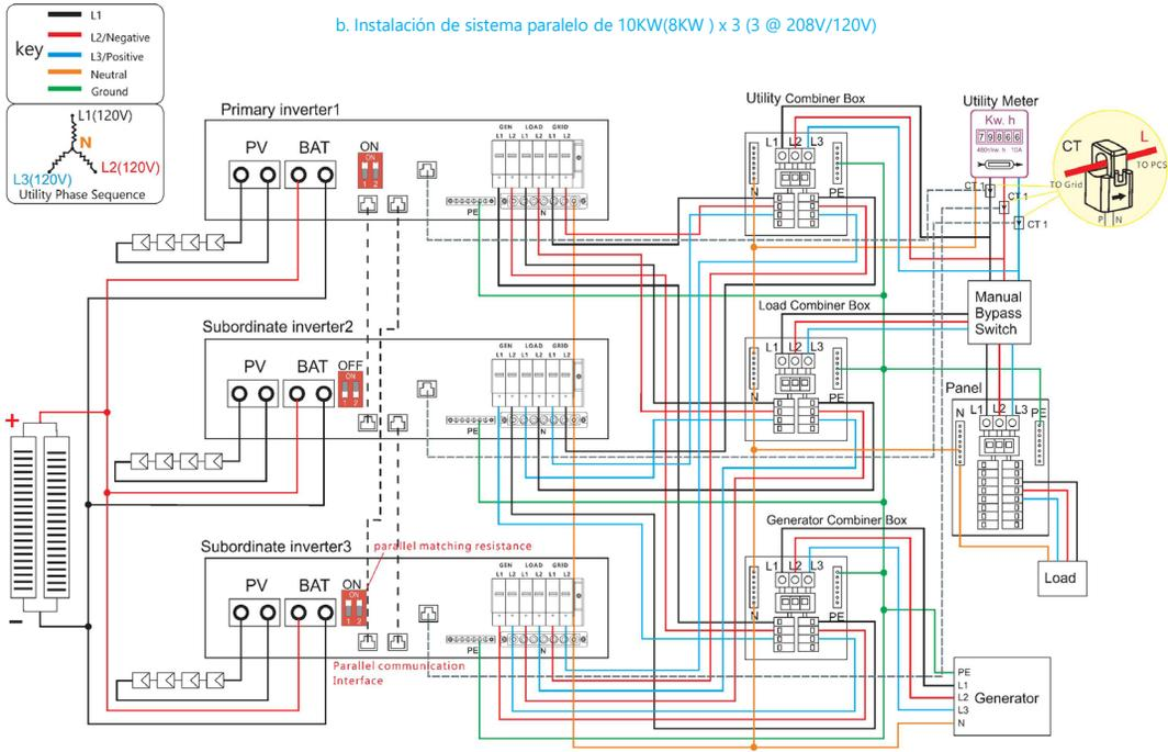
Para conocer los requisitos de seguridad de la conexión, consulte 2020/2023 NEC 705.11 o 2017 NEC 705.12A
