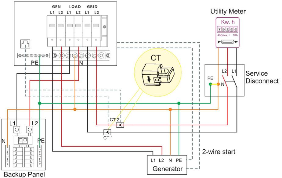
Cuando se pone en marcha el generador, todas las cargas conectadas al EPS Load serán suministradas por el generador. Mientras tanto la batería se carga.
