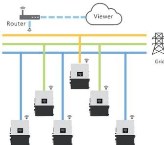
**F. Sistema de almacenamiento de energía con función de nivelación de picos**
