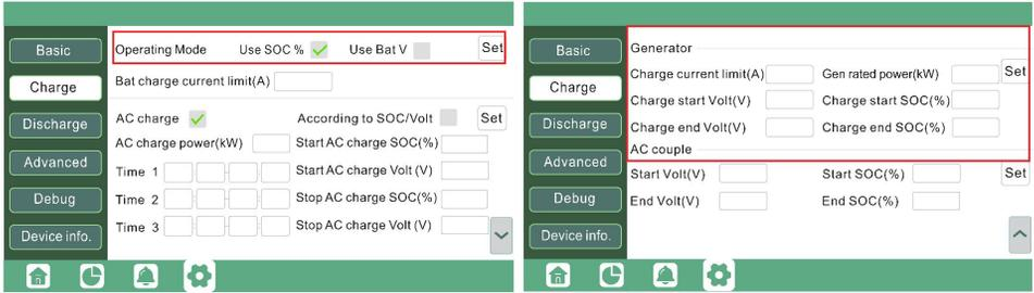
Esto depende de la configuración de control de carga de la batería. El sistema utilizará ya sea el SOC (estado de carga) de la batería o el voltaje de la batería para determinar si el sistema necesita arrancar o detener el generador.
