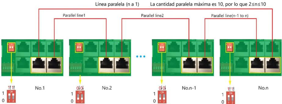
Si el cable paralelo no es suficiente o no es lo suficientemente largo, haga un cable pin a pin recto.
