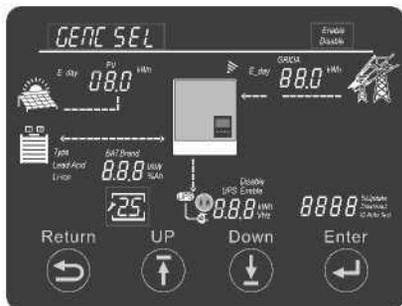
Configuración de carga del generador
