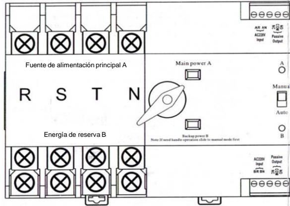
Figura 4 Dirección de montaje correcta
