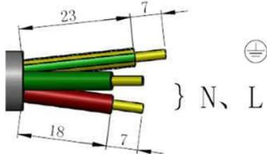
b) Fije los cables en la posición correcta. Torque de 0.8 Nm. Intente tirar del cable para asegurarse de que esté bien conectado.
