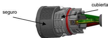
c) Inserte el seguro en el cuerpo del conector y apriete la tuerca con un torque de 2.5+/-0.5 Nm
