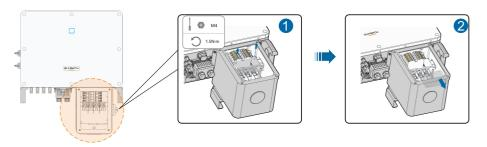
Paso 4 Use una llave Allen para quitar el tornillo en la parte inferior de la caja de conexiones de ca
