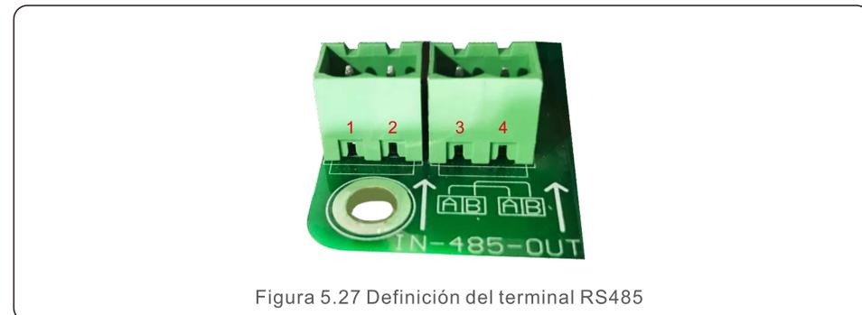
Figura 5.27 Definición del terminal RS485
