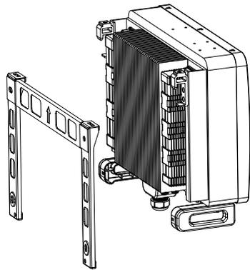
Figura 5.5 Instalación del inversor
