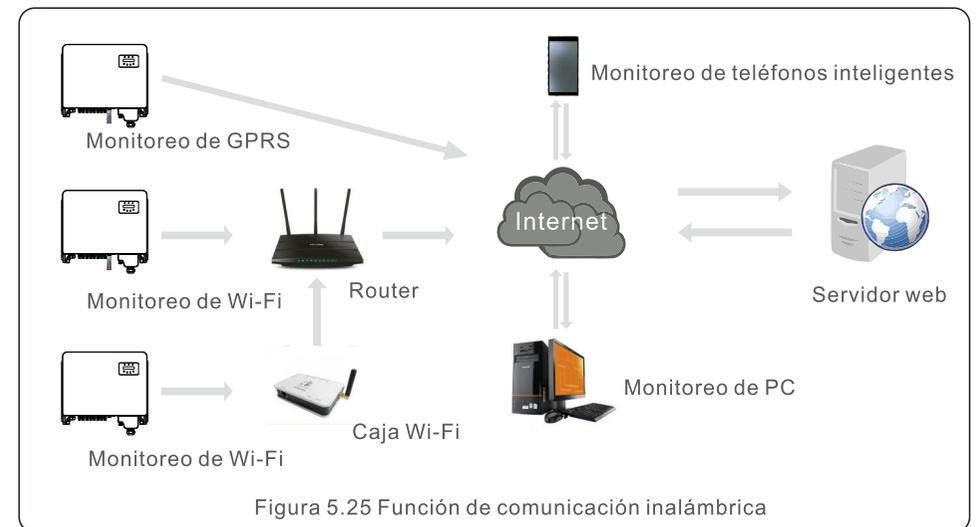
Figura 5.25 Función de comunicación inalámbrica
