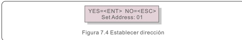
Pulse las teclas ARRIBA/ABAJO para fijar la dirección. Pulse la tecla ENTER para guardar los ajustes.
