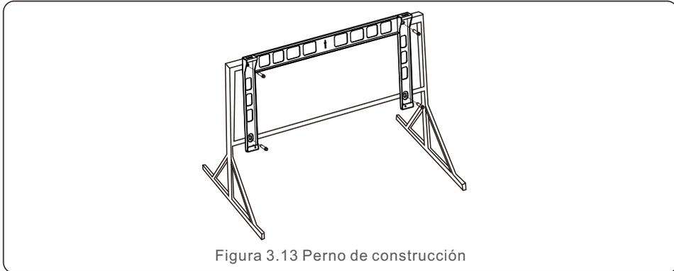
4) Levante el inversor por encima del soporte y luego deslícelo hacia abajo para asegurarse de que coinciden perfectamente.
