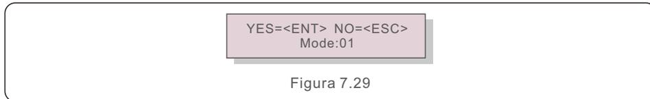
En modo "01", como se muestra en la figura 7.30, el modo de limitación promedio, la potencia de salida de cada fase es el promedio de la potencia de carga trifásica, y es más que la fase de la menor potencia en tres fases.
