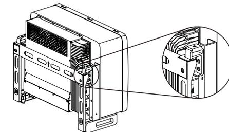
Figura 3.7 Instalar el inversor
