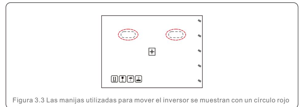
2. Se necesitan dos personas para sacar el inversor de la caja de transporte. Utilice las asas integradas en el disipador de calor para sacar el inversor de la caja (véase la figura 3.4).
