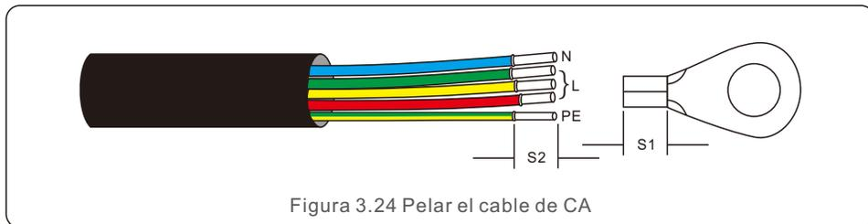
**NOTA:** S2 (longitud de pelado del aislamiento) es 2mm-3mm más largo que S1. (Área de engaste de los terminales de cable OT)
