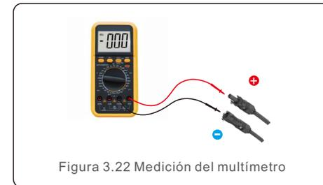
Figura 3.22 Medición del multímetro
