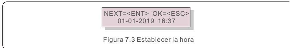
Pulse las teclas UP/DOWN para ajustar la hora y la fecha. Pulse la tecla ENTER para pasar de un dígito a otro (de izquierda a derecha). Pulse la tecla ESC para guardar los ajustes y volver al menú anterior.
