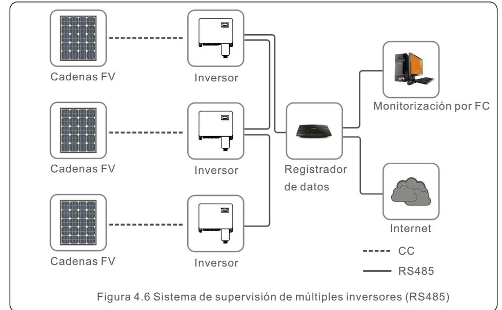
Figura 4.6 Sistema de supervisión de múltiples inversores (RS485)
