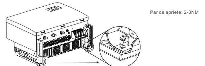
Figura 3.8 Fijar el inversor
