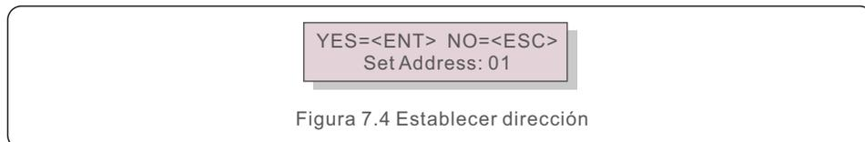
Pulse las teclas UP/DOWN para fijar la dirección. Pulse la tecla ENTER para guardar los ajustes.
