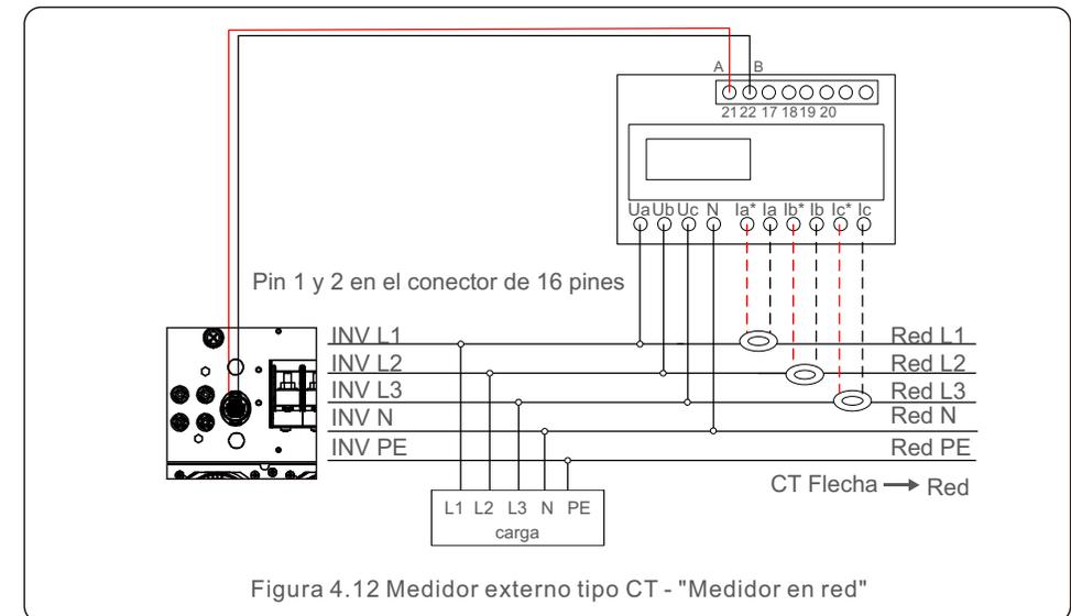
Figura 4.12 Medidor externo tipo CT - "Medidor en red"
