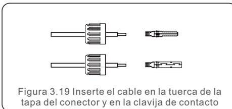
Figura 3.19 Inserte el cable en la tuerca de la tapa del conector y en la clavija de contacto
