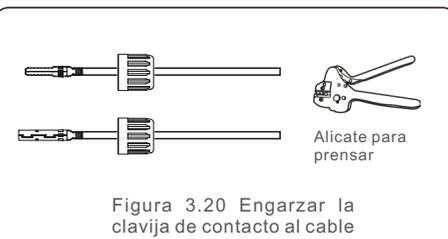
Figura 3.20 Engarzar la clavija de contacto al cable
