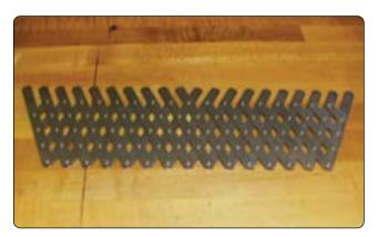
Figure 4-6. Rivet spacer.
