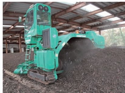
水を入れながら攪拌し、空気を入れ「完熟」するまで発酵させる。中は80℃にまで上がる。
