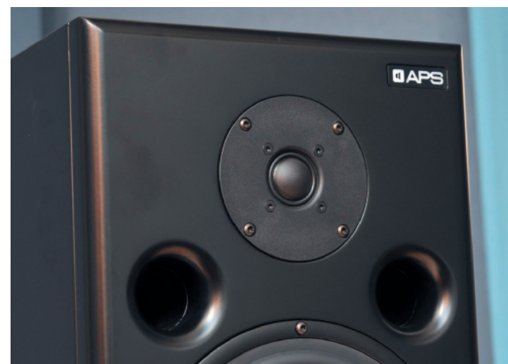
25-mm-Gewebekalotte ohne Schallführung. Darunter angeordnet die Bassreflexstapel mit gerundeten Auslässen zur Reduzierung der Strömungsgeräusche.
