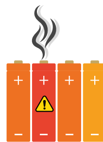
Particules de métaux lourds: fumé foncé. Gaz toxiques inflammables: fumée blanche.
