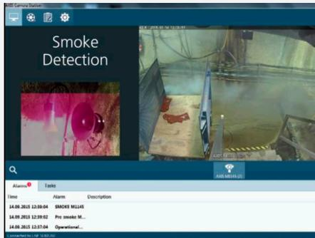
Le test mené sur les sites de SAMCON a démontré que le logiciel SmokeCatcher détectait, de manière fiable, les départs de fumée et les distinguait des autres mouvements (comme les passants qui déambulent).
