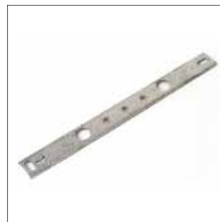
Support 153 démontable (réf 253899) : Permet de sceller les coudes muraux avec un entraxe de 153 mm et de le démonter après séchage du scellement afin d'être réutilisé.
