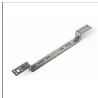
Support 097-153 (réf. 139211) et 045-80 (réf. 139441) : Fixation de deux coudes muraux en saignée, avec entraxe de 97 ou 153 pour l'un, de 40 ou 80 mm pour l'autre.
