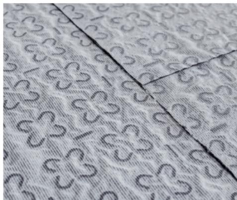
Respect du pas de pose multiple de 50 mm grâce au motif imprimé sur la plaque.
