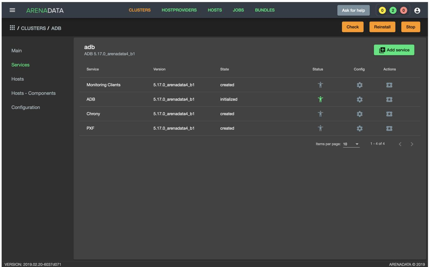
Рис.3.39.: Кластер инициализирован, доступны кнопки “Check”, “Reinstall”, “Stop”
