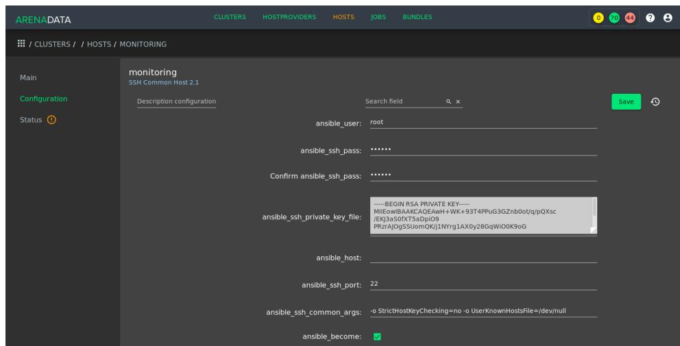
Рис.6.1.: Страница настройки для хоста в **ADCM** на примере хостпровайдера ssh
