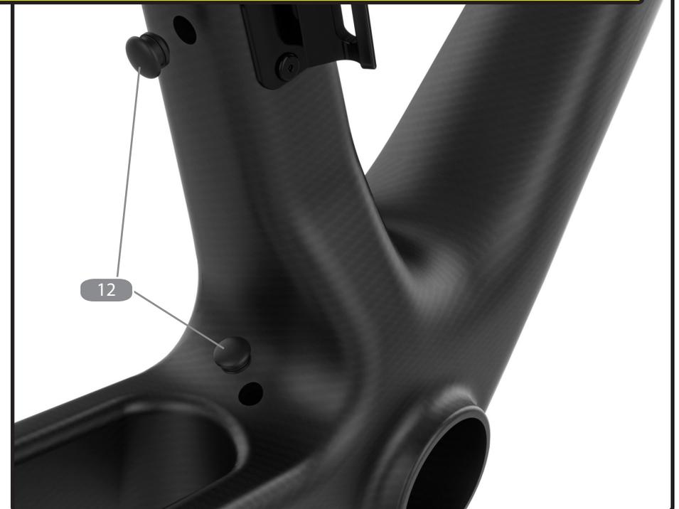
Utiliser l'ouverture rectangulaire sous le boîtier de pédalier pour connecter tous les câbles.
