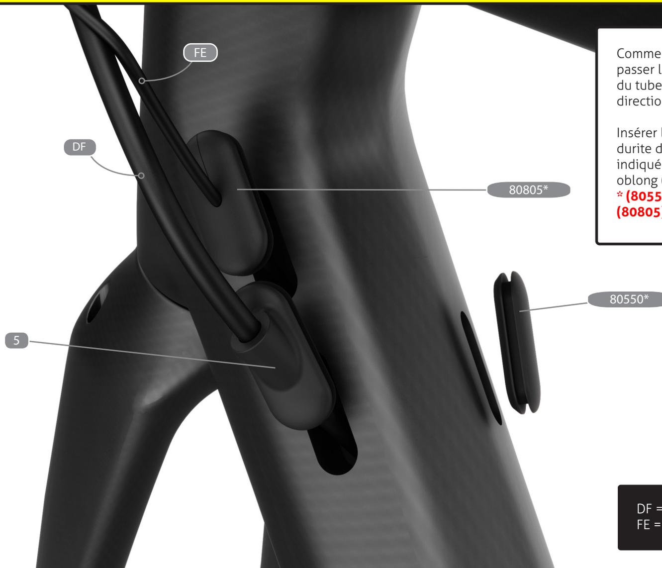
Commencer l'installation en faisant passer les câbles par le trou en haut du tube diagonal près du tube de direction.
