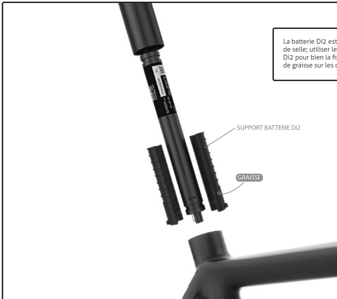
La batterie Di2 est cachée dans la tige de selle; utiliser le support de batterie Di2 pour bien la fixer. Appliquer un peu de graisse sur les deux pièces.
