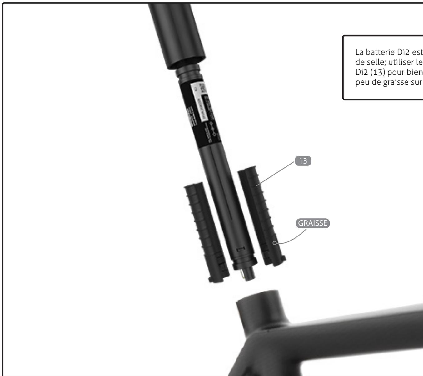
La batterie Di2 est cachée dans la tige de selle; utiliser le support de batterie Di2 (13) pour bien la fixer. Appliquer un peu de graisse sur les deux pièces.
