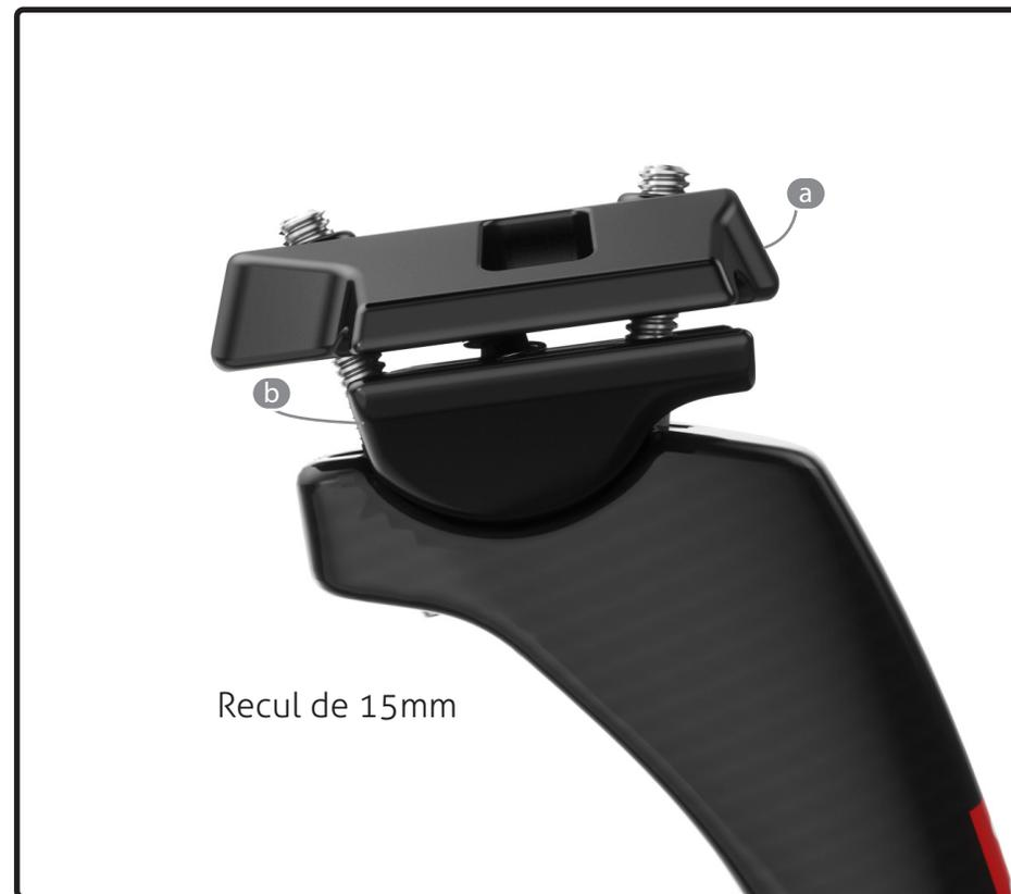
La fixation supérieure (a) et la fixation inférieure (b) peuvent être inversées pour ajuster le recul de la selle entre 15 ou 25 mm.
