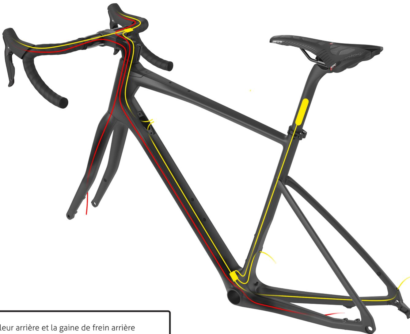
Le câble de dérailleur arrière et la gaine de frein arrière doivent être acheminés/positionnés par-dessus le cylindre en carbone du boîtier de pédalier.
