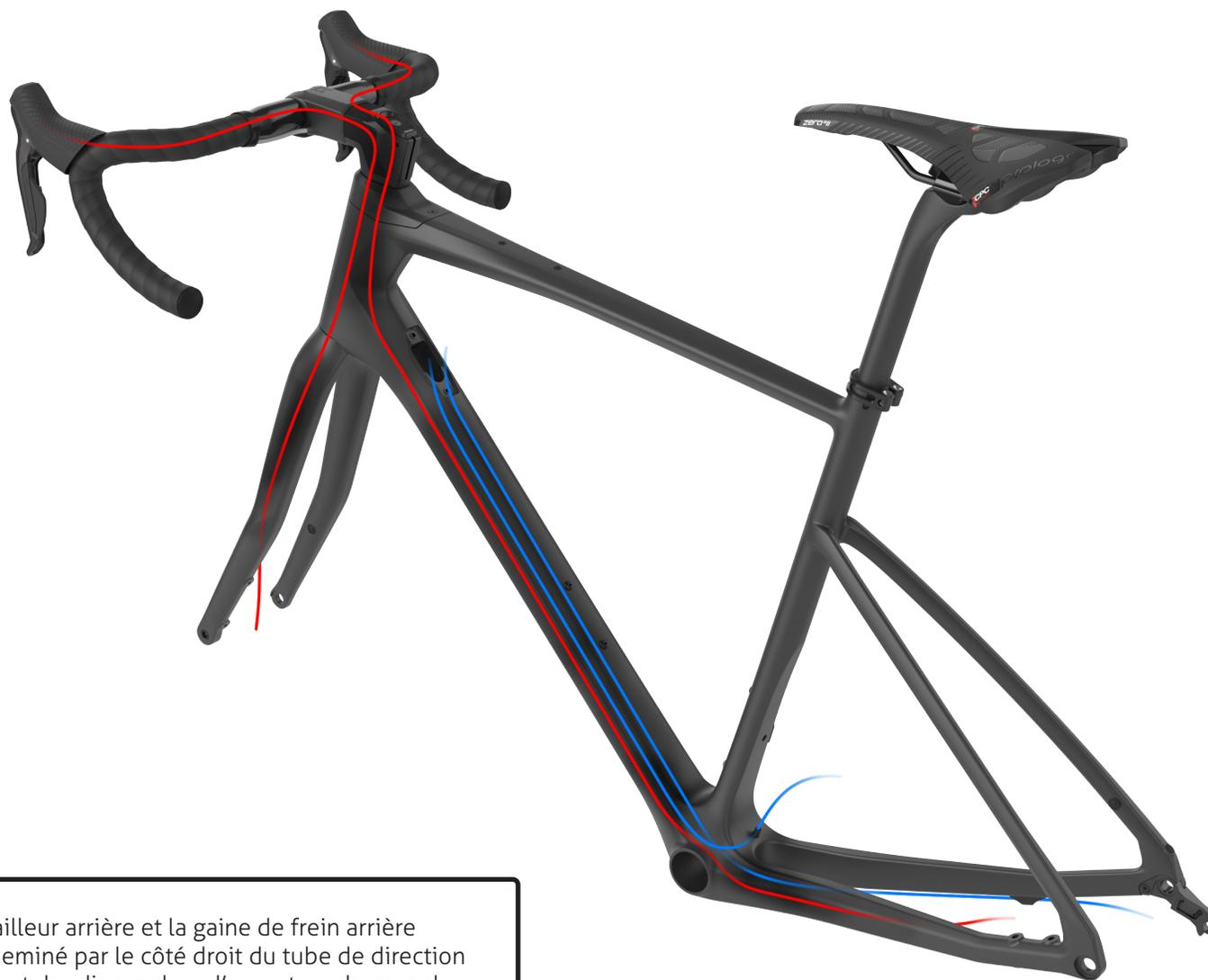
Le câble de dérailleur arrière et la gaine de frein arrière doivent être acheminé par le côté droit du tube de direction vers l'intérieur du tube diagonal par l'ouverture de console.
