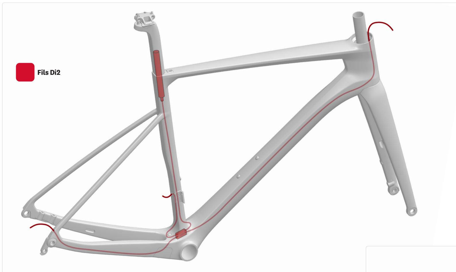
1. Avec un câble de tirage\*, guidez les quatre fils Di2 depuis leurs trous respectifs, jusqu'aux ouvertures du boîtier de pédalier (sous le cadre). Passez tous les fils **derrière** le tunnel du pédalier en les laissant pendre hors du cadre par l'ouverture.
