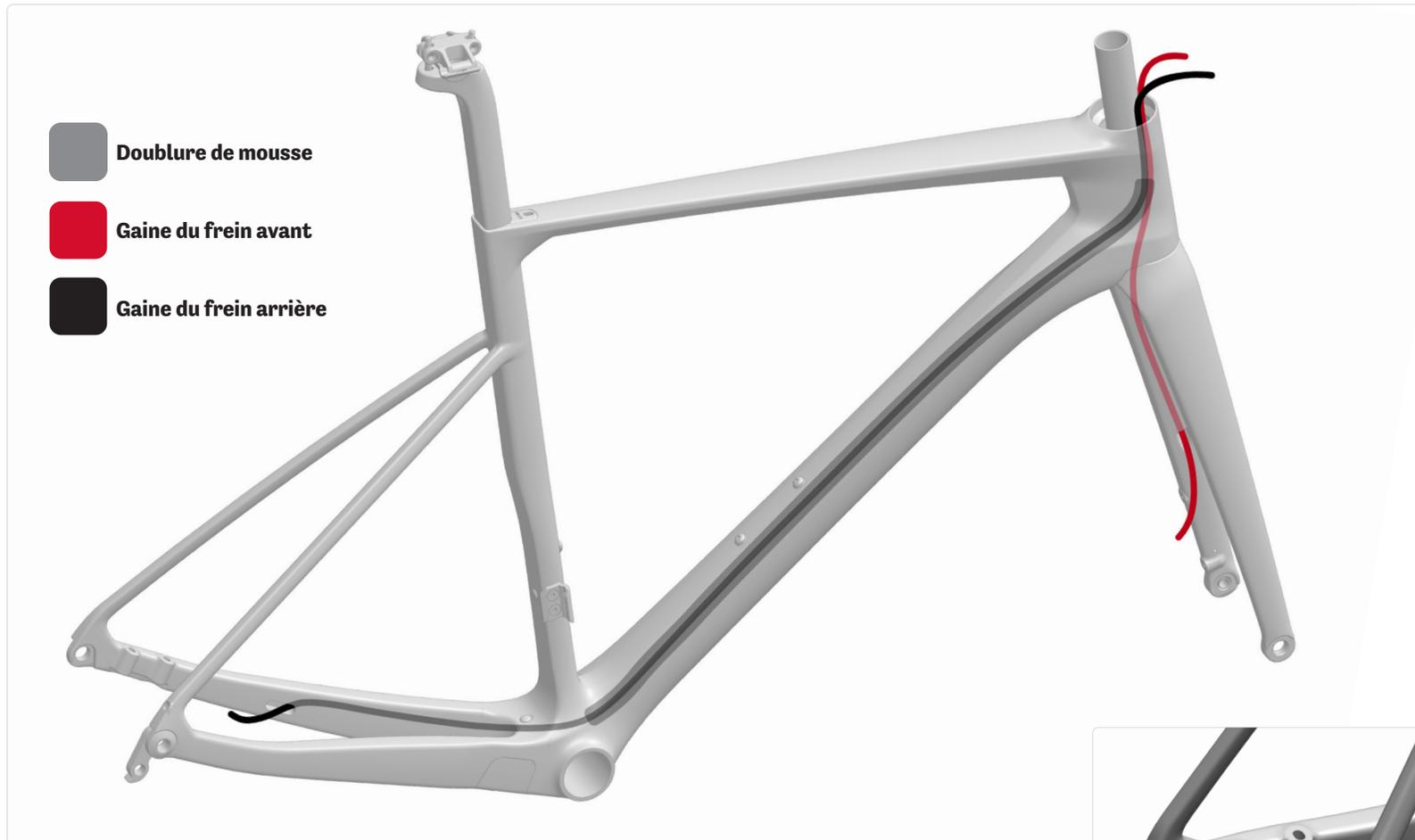
1. Enfilez la gaine du frein arrière par le trou de la branche de gauche de la fourche arrière et le faire ressortir par l'ouverture du jeu direction. Passez la gaine **sous** le tunnel de la boîte de pédalier.
