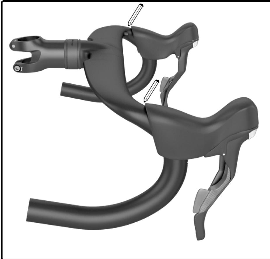
1. Installer les manettes de frein à la hauteur voulue et tracer un trait avec un crayon blanc à l'extrémité des repose-mains.
