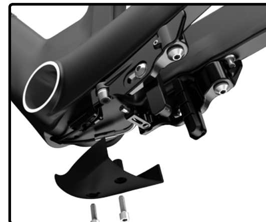
6. Installation du frein arrière
