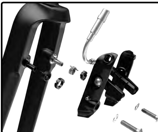
5. Installation du frein avant
