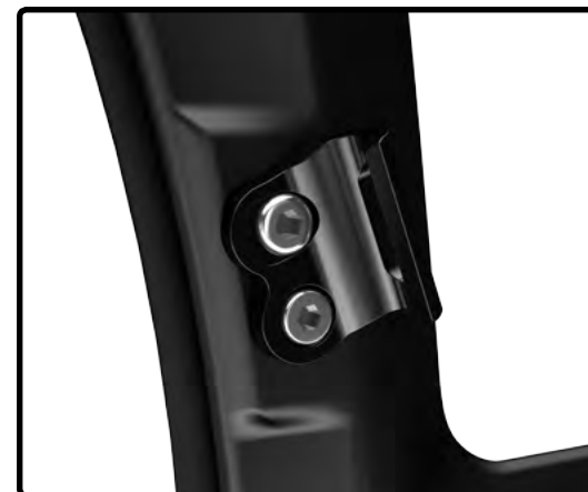
9. Ajustement du support de dérailleur
