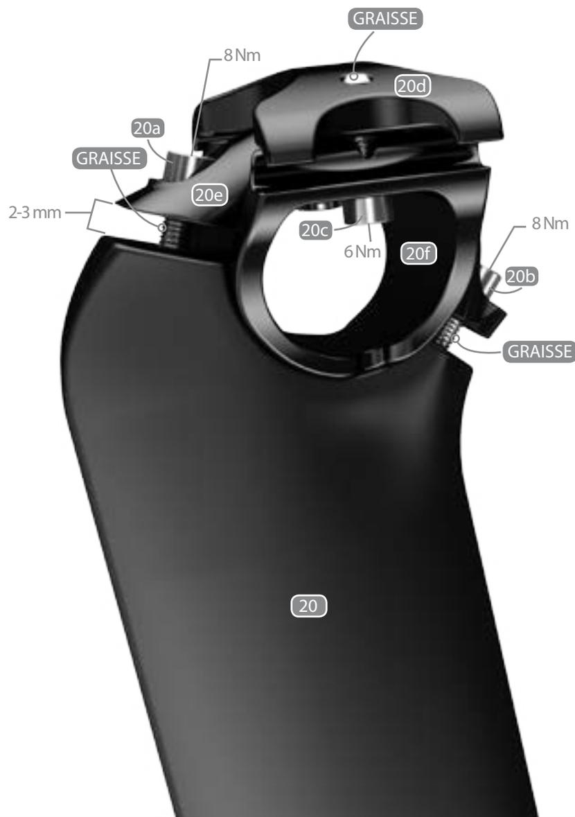
11.1 Installez la selle sur le support de selle (20f) et serrez légèrement l'attache des rails de selle en utilisant une clé hexagonale à bout sphérique.
