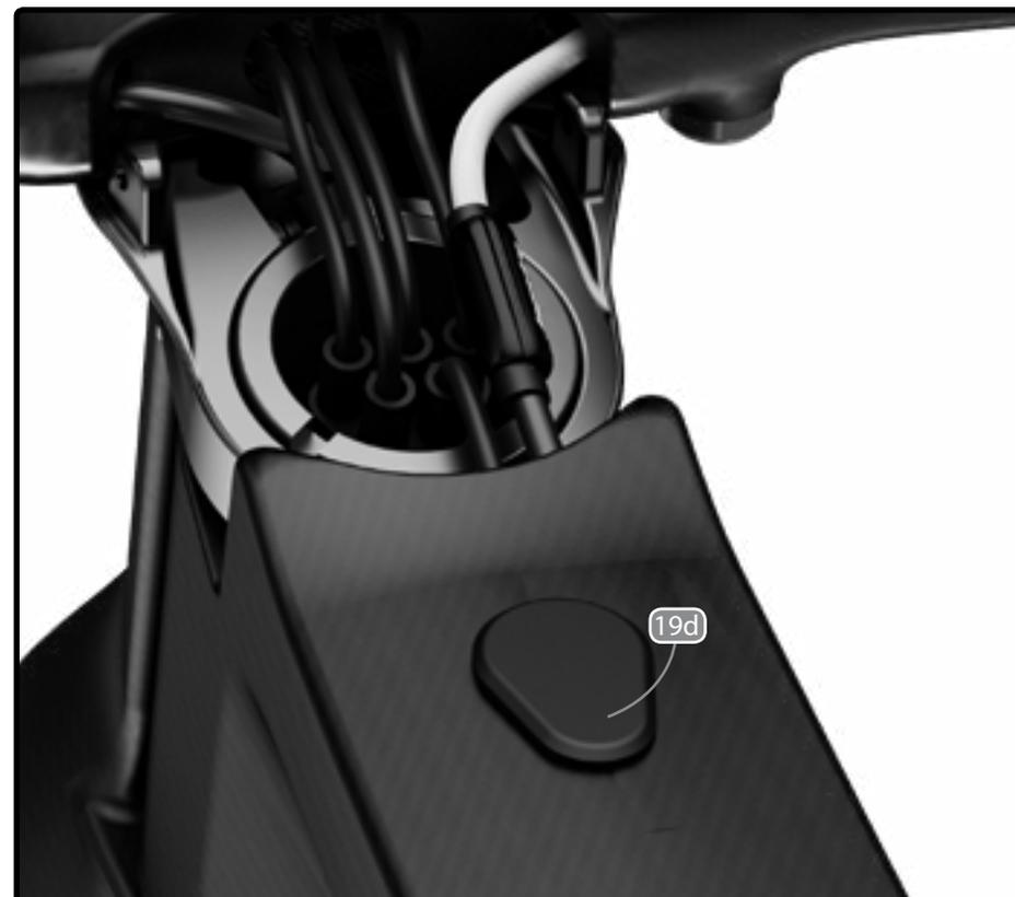
Utilisez le bon œillet sur le tube supérieur pour fixer correctement le câble (selon le type de transmission : électronique ou mécanique).
