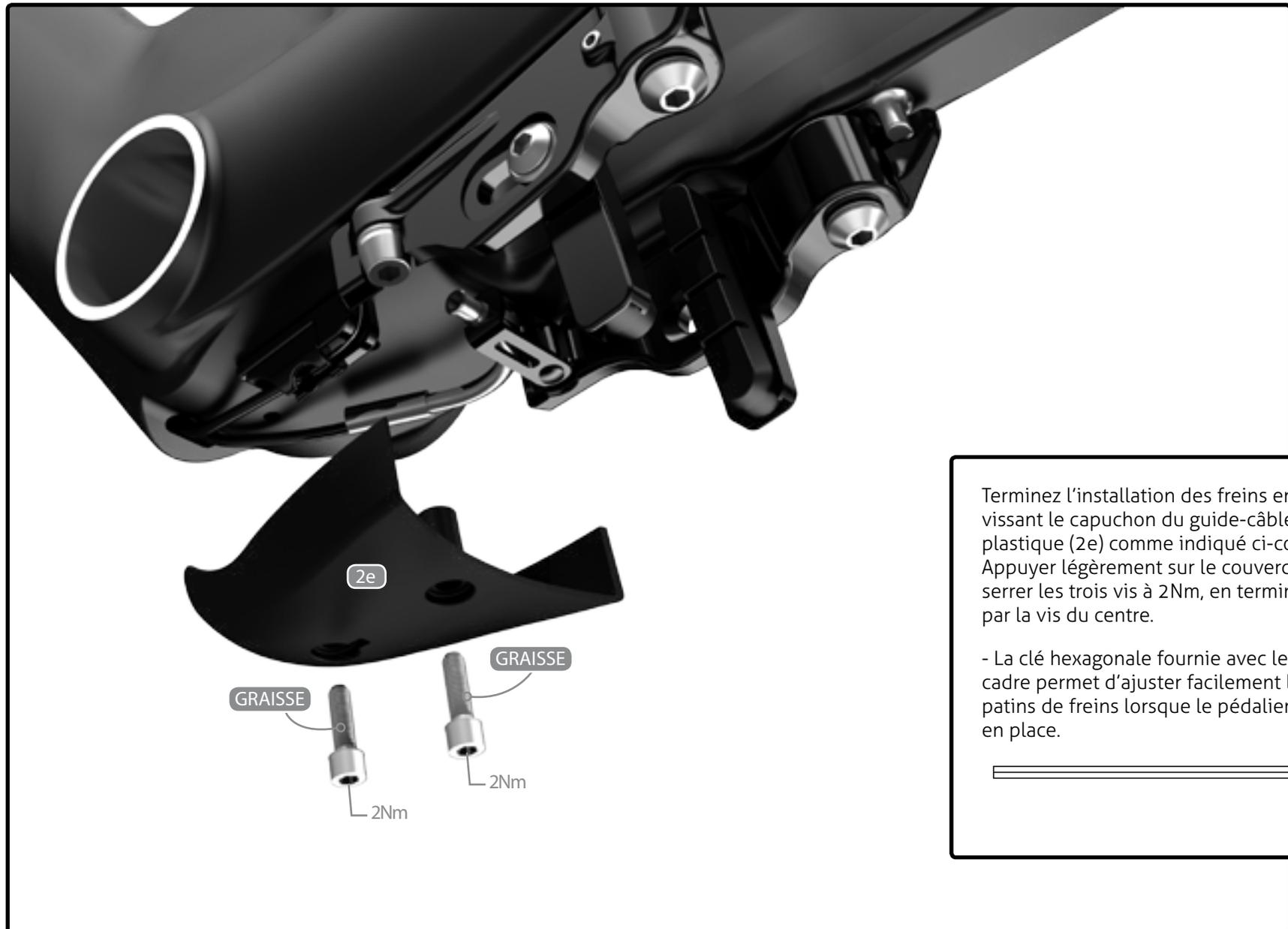
Terminez l'installation des freins en vissant le capuchon du guide-câble en plastique (2e) comme indiqué ci-contre. Appuyer légèrement sur le couvercle et serrer les trois vis à 2Nm, en terminant par la vis du centre.
