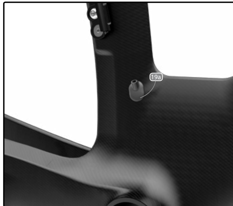
Utilisez le bon œillet pour le câble du dérailleur avant selon le type de transmission : mécanique (19b) et électronique (19a).
