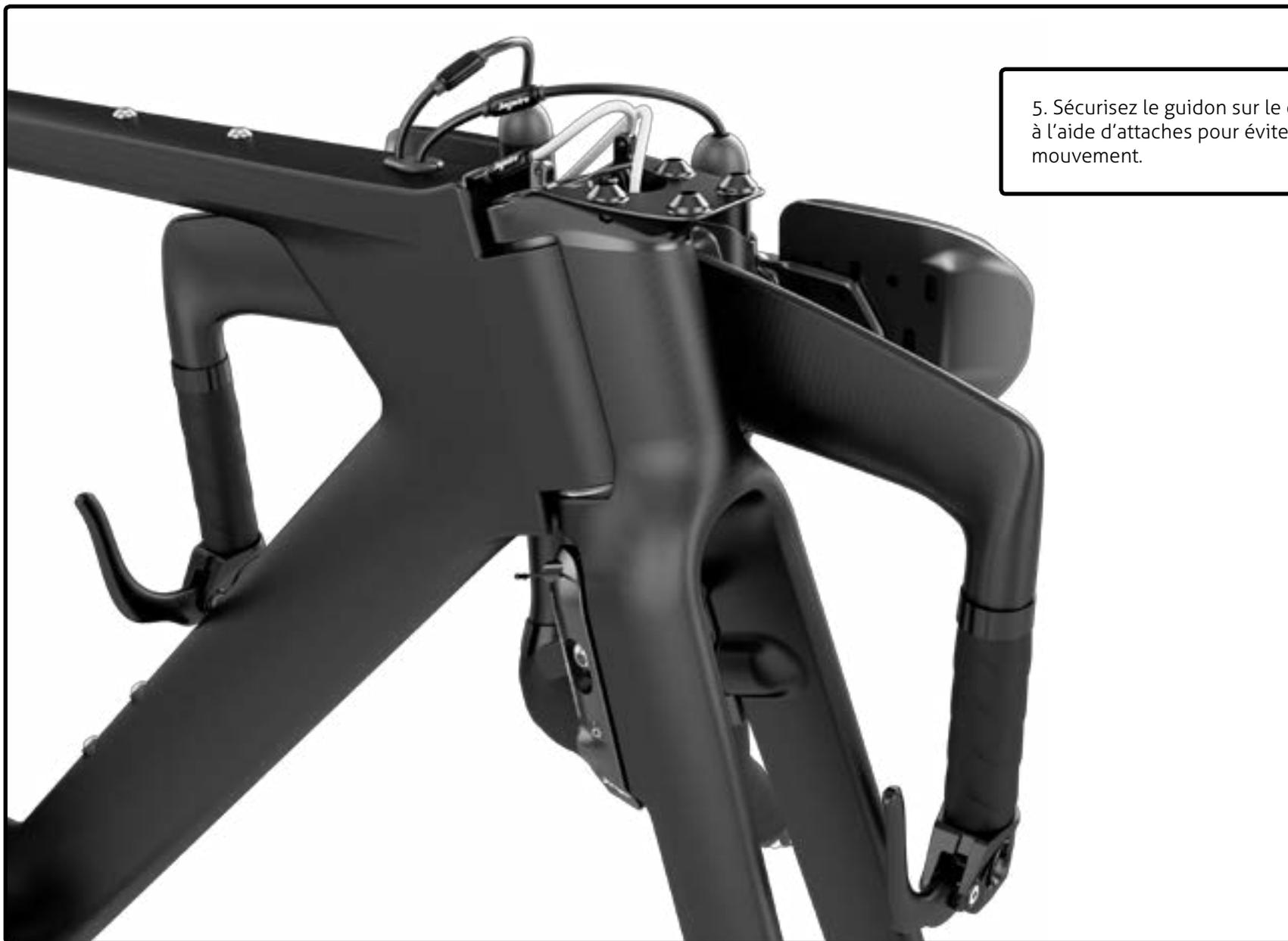
5. Sécurisez le guidon sur le cadre à l'aide d'attaches pour éviter tout mouvement.
