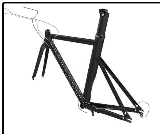
2. Passage des gaines
