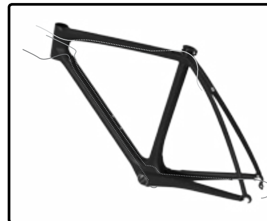
3. Passage des gaines
