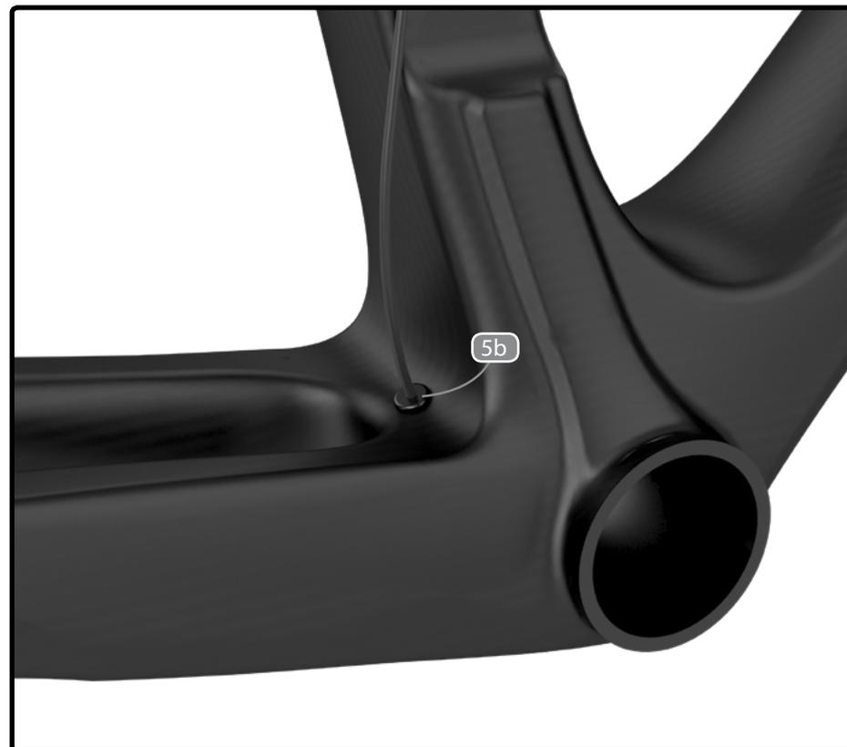
Pour une configuration mécanique, utiliser le tuyau guide câble (4e) pour le dérailleur avant. Pour une configuration électronique, retirer le tuyau et utiliser l'oeillet 5b pour fixer le câble correctement.
