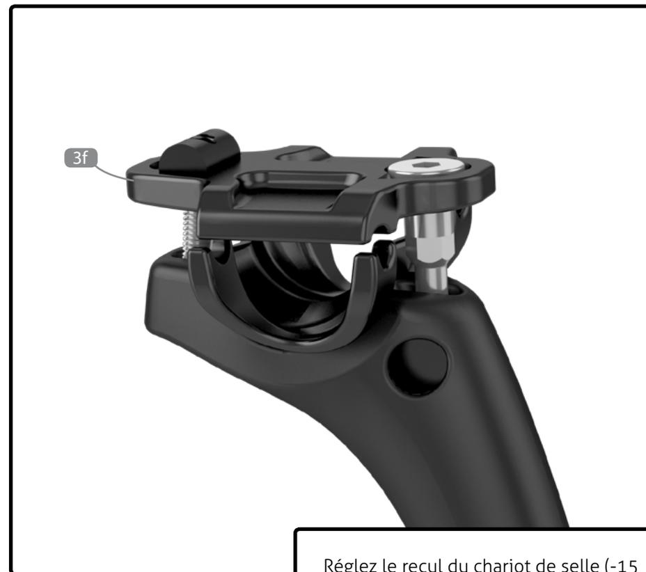
Réglez le recul du chariot de selle (-15 à -25 mm) en inversant la position de l'attache de rails (3f).
