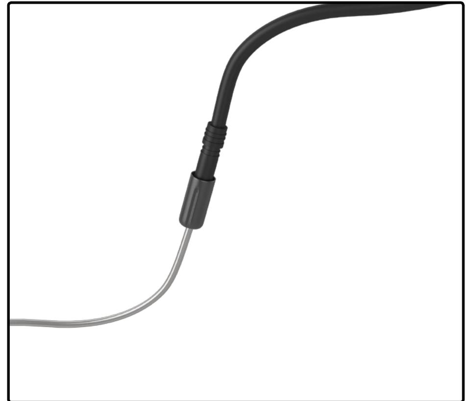
Le passage du câblage Di2 peut se faire facilement en suivant ce truc simple : utilisez un câble de frein et une ferrule en métal pour fixer le câble Di2. Pour plus d'informations sur l'installation du système électronique Shimano Di2, visitez le <http://si.shimano.com>.
