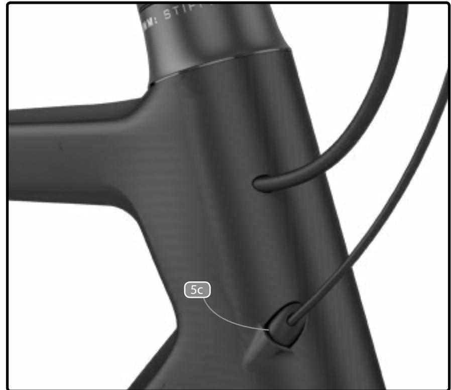
Utilisez le bon œillet pour fixer le câble sur le tube supérieur (selon le type de transmission : mécanique et électronique).
