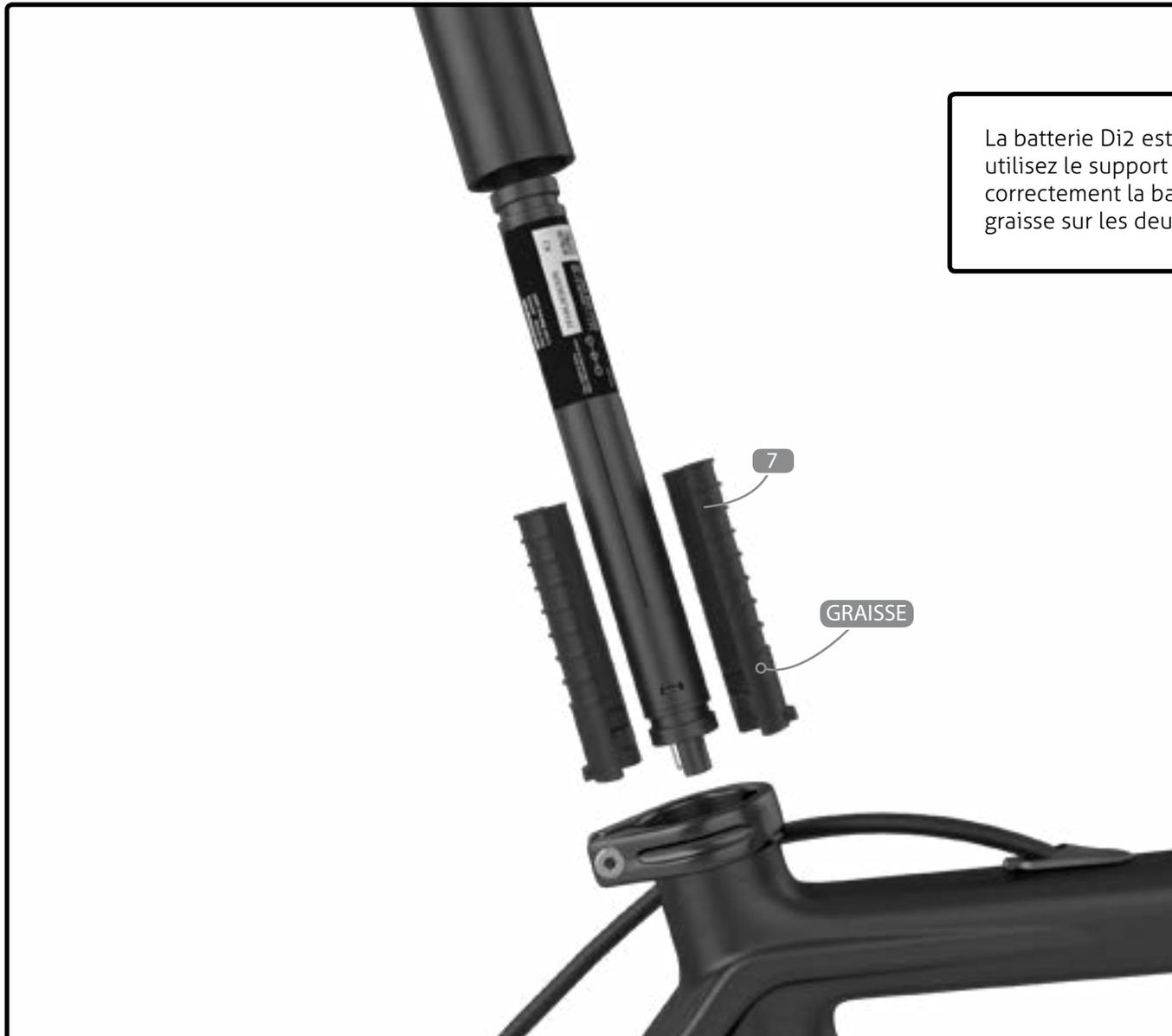
La batterie Di2 est cachée sous la tige de selle; utilisez le support de batterie Di2 pour fixer correctement la batterie. Appliquez un peu de graisse sur les deux pièces.
