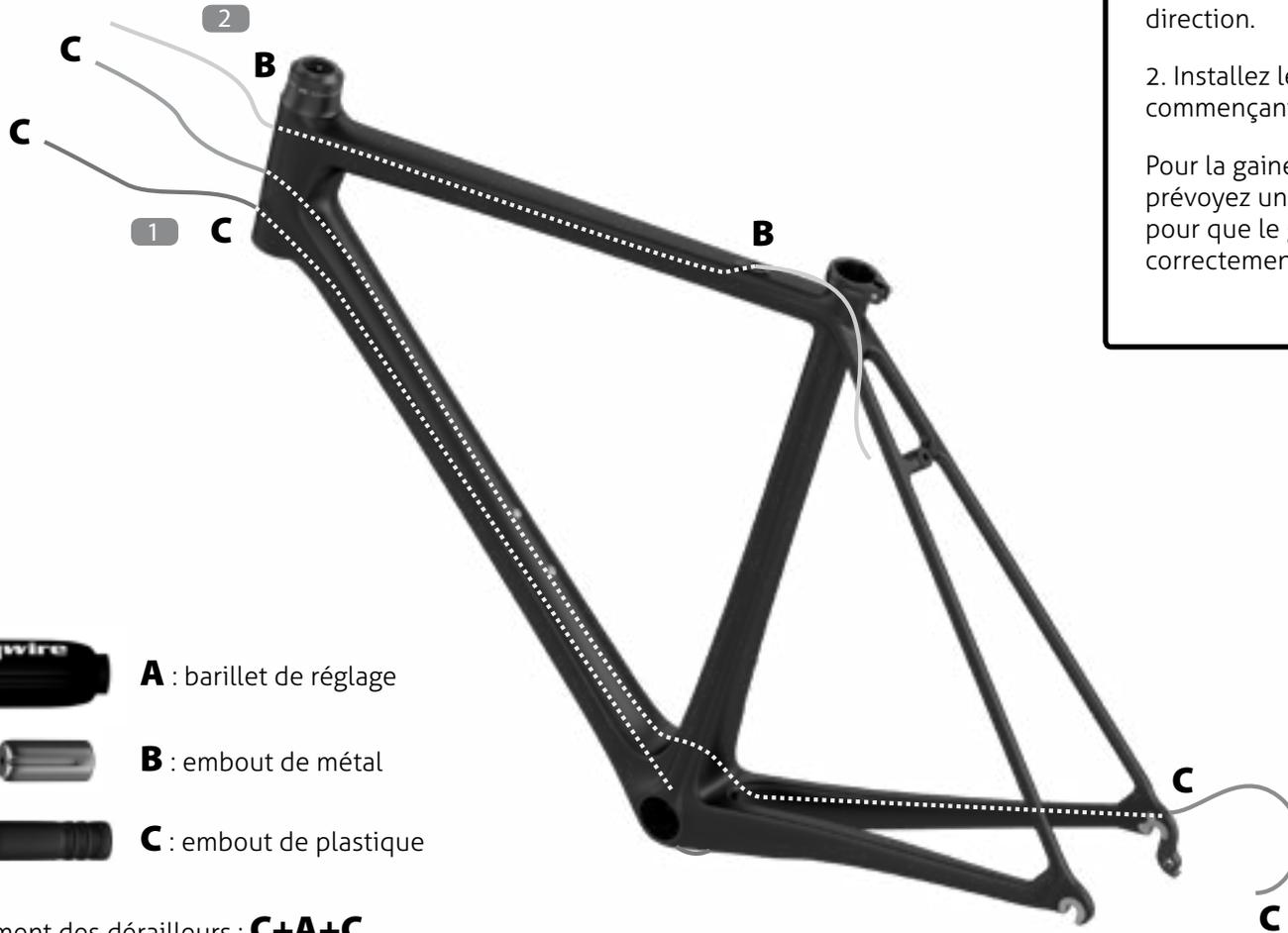
1. Installez le câble du dérailleur arrière en commençant par le tube de direction.
