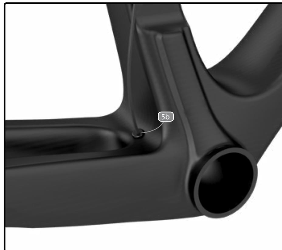
Pour une configuration mécanique, utiliser le tuyau guide câble (4e) pour le dérailleur avant. Pour une configuration électronique, retirer le tuyau et utiliser l'oeillet 5b pour fixer le câble correctement.
