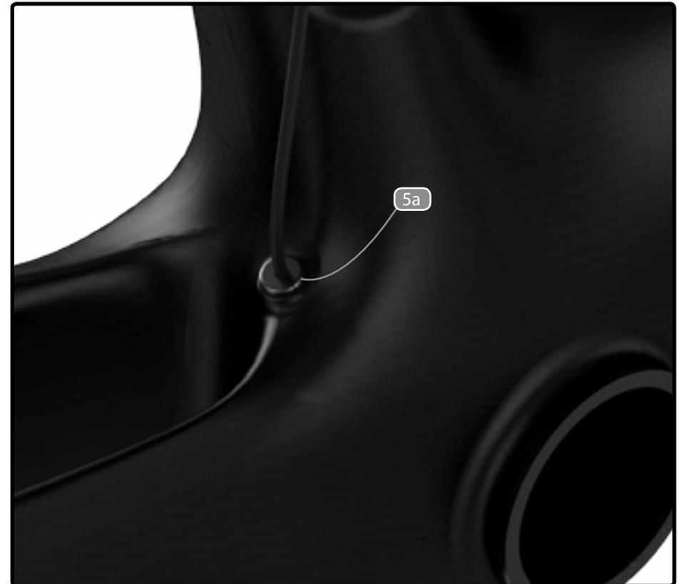
Dans une configuration mécanique, utilisez le tube pour guide-câble fourni (4f) pour le dérailleur avant. Pour une configuration de transmission électronique, retirez le tube pour guide-câble et utilisez le bon œillet (5a) pour fixer le câble correctement.
