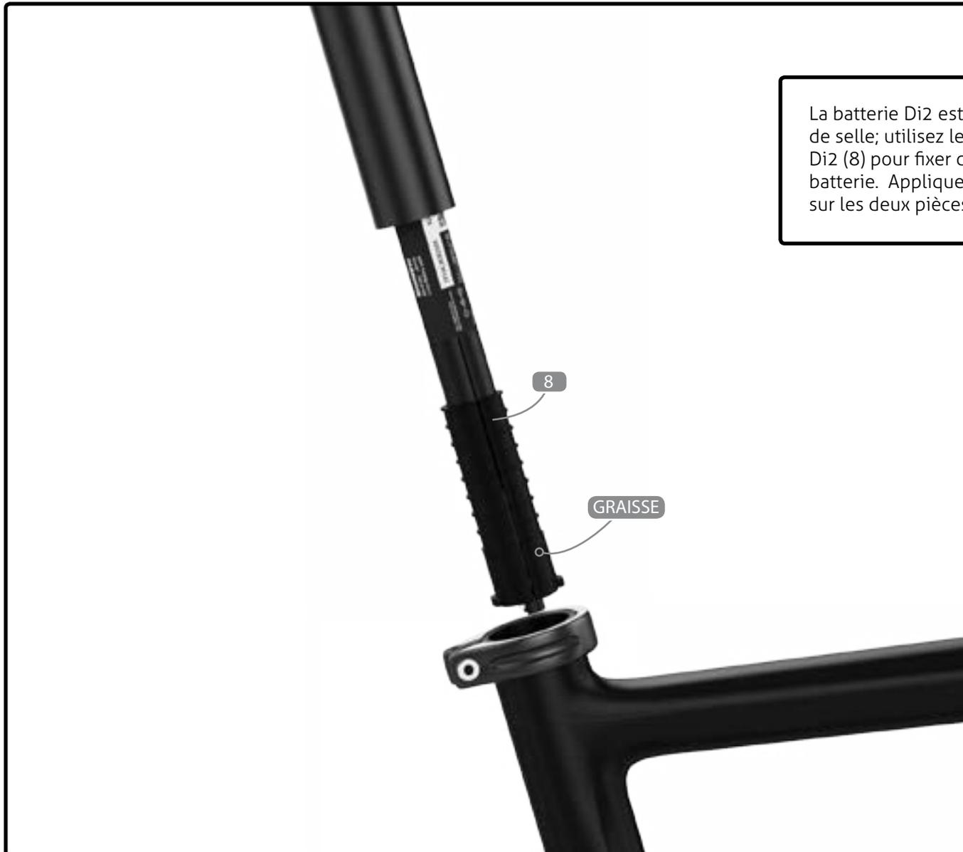
La batterie Di2 est cachée dans la tige de selle; utilisez le support de batterie Di2 (8) pour fixer correctement la batterie. Appliquez un peu de graisse sur les deux pièces.
