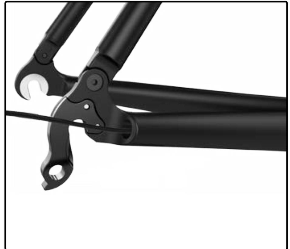
Utilisez le bon œillet et la bonne butée de câble pour le dérailleur arrière (selon le type de transmission : mécanique ou électronique).
