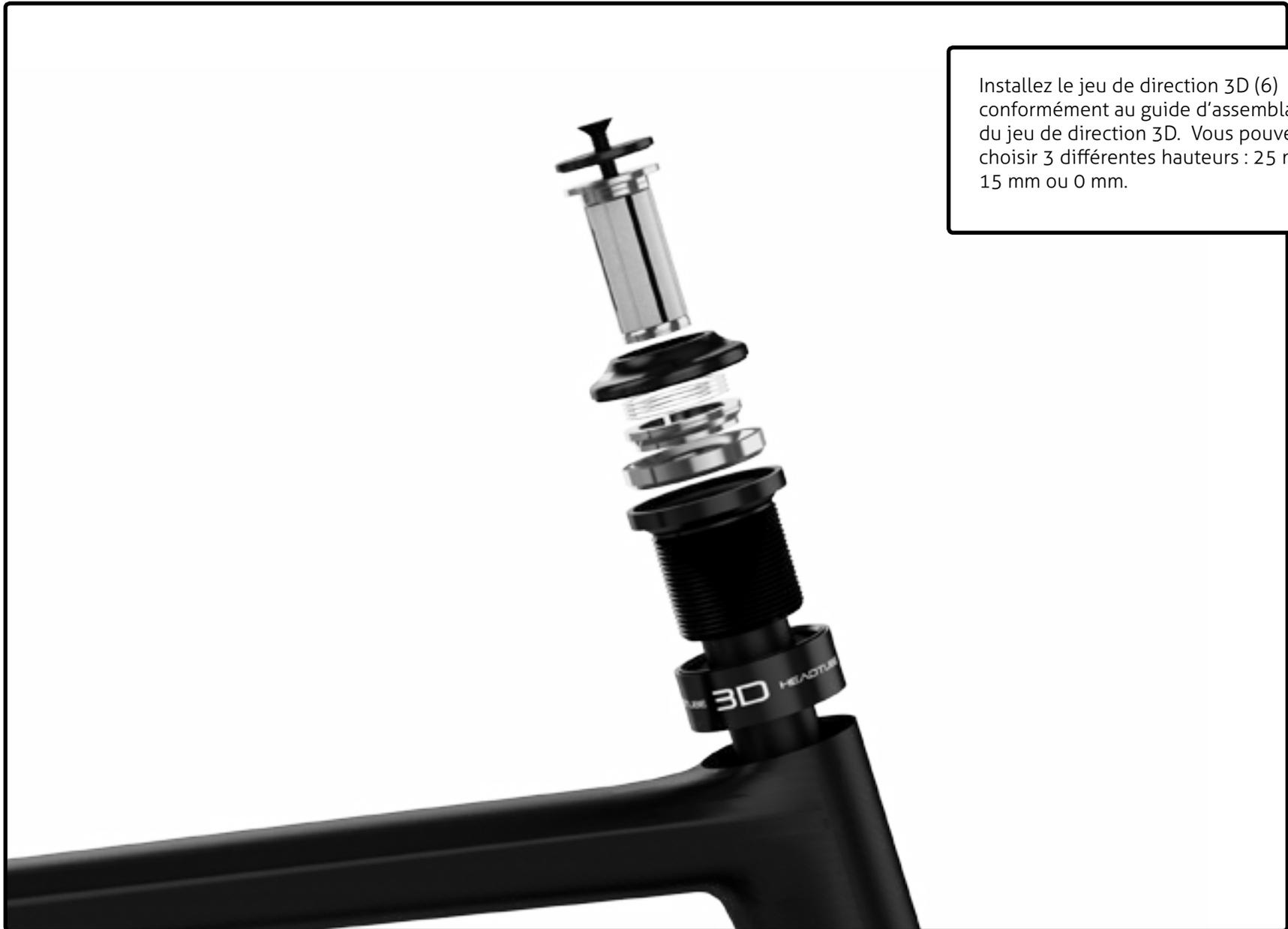
Installez le jeu de direction 3D (6) conformément au guide d'assemblage du jeu de direction 3D. Vous pouvez choisir 3 différentes hauteurs : 25 mm, 15 mm ou 0 mm.
