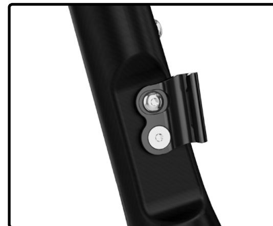
6. Derailleur hanger adjustment
