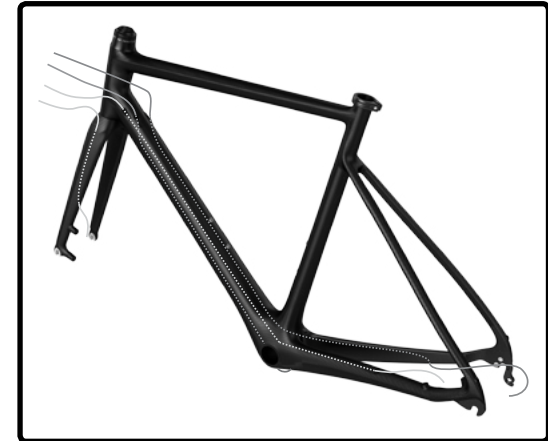
3. Passage des gaines
