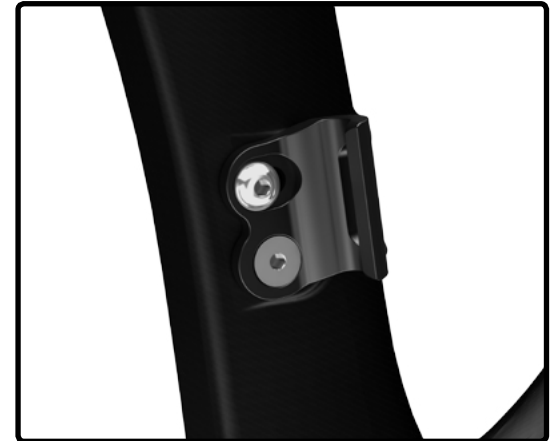
9. Derailleur hanger adjustment
