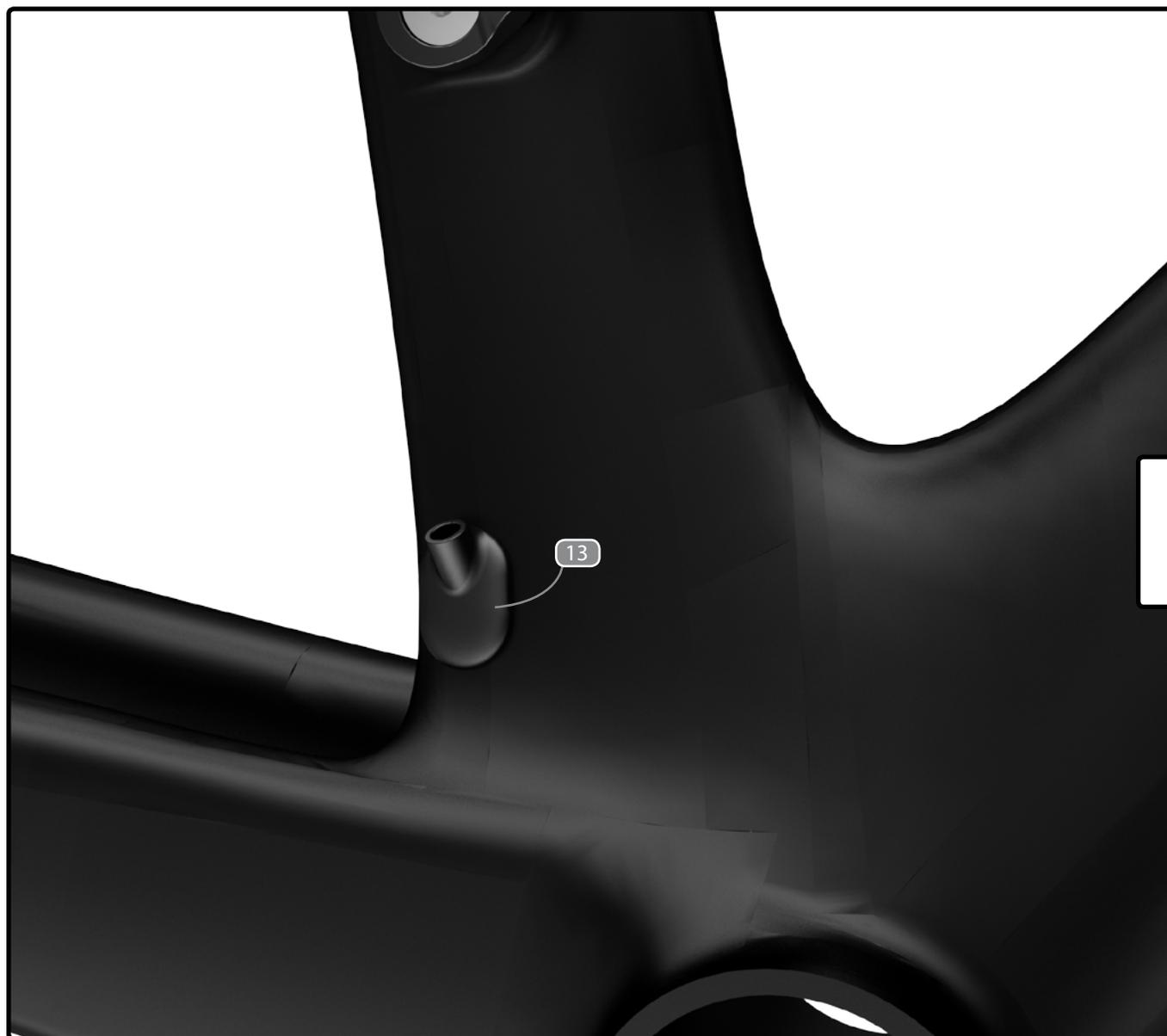
Pour une transmission électronique, utilisez l'œillet (13) pour fixer le câble du dérailleur avant.
