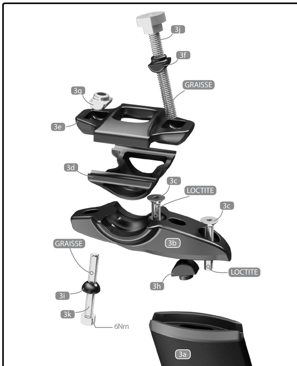
8.1 Installez la selle sur le support de selle (3d) et serrez l'attache des rails de selle (3e) à 6 Nm, au maximum, en utilisant le boulon en demi-lune (3k).
