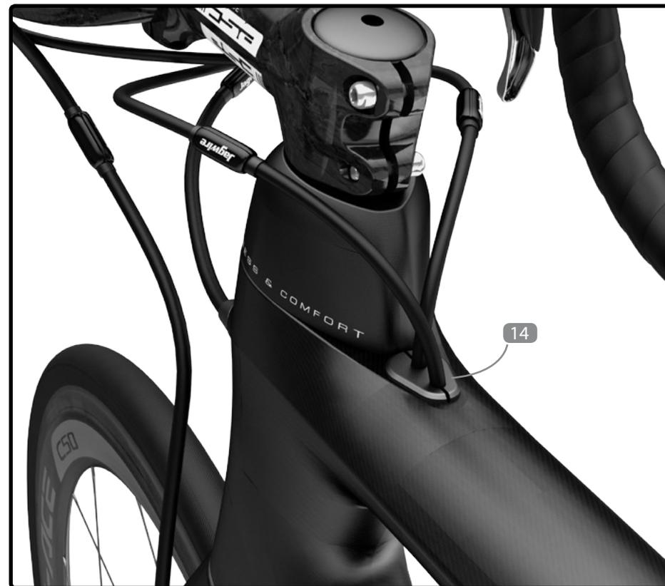
Utilisez le bon œillet pour bien fixer le câble sur le tube supérieur (selon le type de transmission : mécanique ou électronique).
