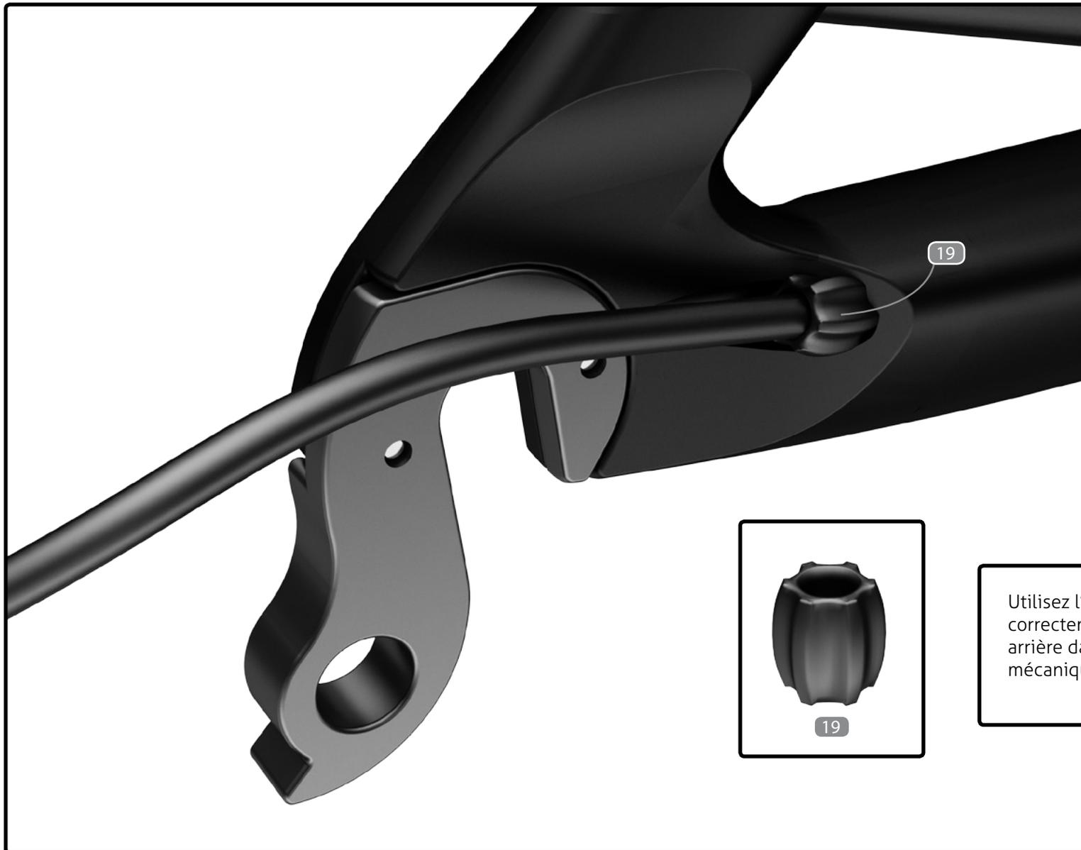
Utilisez l'œillet fourni (19) pour fixer correctement le câble du dérailleur arrière dans la base (transmission mécanique seulement).
