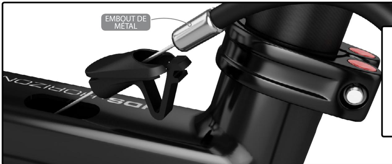
**Section arrière :** Avec un aimant, faire sortir le câble du frein arrière du cadre, et le passer dans la butée arrière du câble. Mesurer correctement la gaine arrière pour éviter qu'il y ait des contacts avec la jambe gauche du cycliste. Pour sortir le câble, il est plus facile de retirer la butée de câble du cadre. Fixer le câble au frein en suivant les instructions du guide d'assemblage du fabricant de freins.
