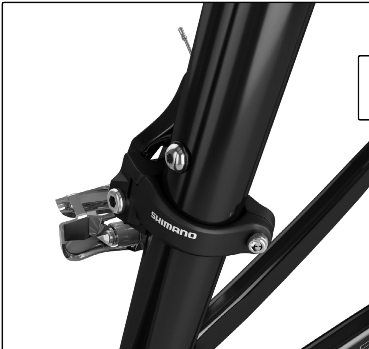
Pour l'installation d'un dérailleur avant de type «braze-on», utiliser un collet adapté à une tige de selle d'un diamètre de **31,8 mm**, comme la pièce **Shimano SM-AD67-M**.
