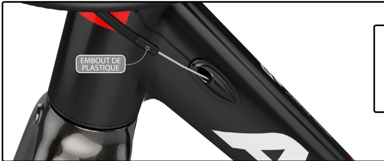
Dérailleurs avant et arrière : Insérer les gaines de câbles dans les sélecteurs jusqu'aux butées de câble. Utiliser des embouts de plastique. Passer les deux câbles dans le cadre par le dessus du tube oblique jusqu'à ce qu'ils ressortent du boîtier de pédalier.
