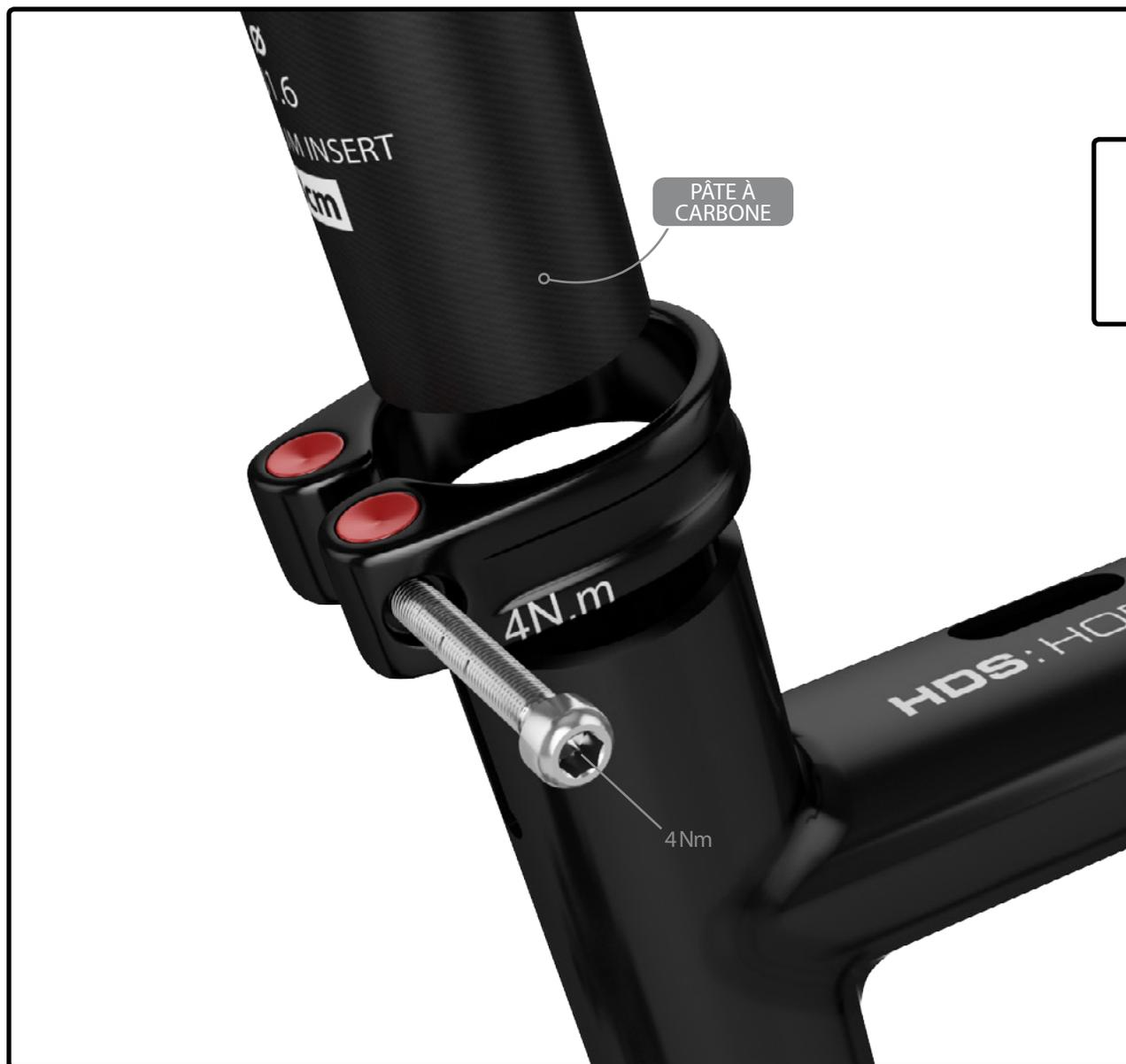
Assembler le collier de tige de selle avec la tige de selle. Appliquer de la pâte à carbone sur la tige de selle à l'endroit où celle-ci s'insère dans le cadre. Serrer la vis à 4 Nm.
