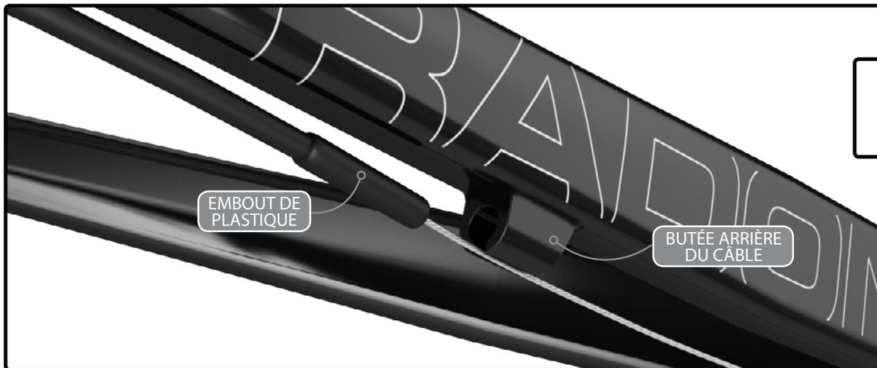
Insérer la gaine du dérailleur arrière dans la butée arrière du câble.
