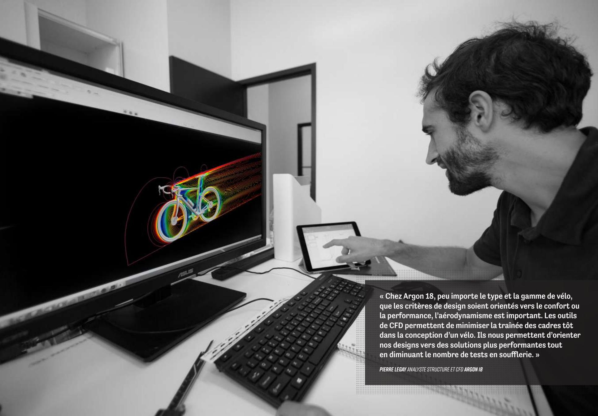
« Chez Argon 18, peu importe le type et la gamme de vélo, que les critères de design soient orientés vers le confort ou la performance, l'aérodynamisme est important. Les outils de CFD permettent de minimiser la traînée des cadres tôt dans la conception d'un vélo. Ils nous permettent d'orienter nos designs vers des solutions plus performantes tout en diminuant le nombre de tests en soufflerie. »
